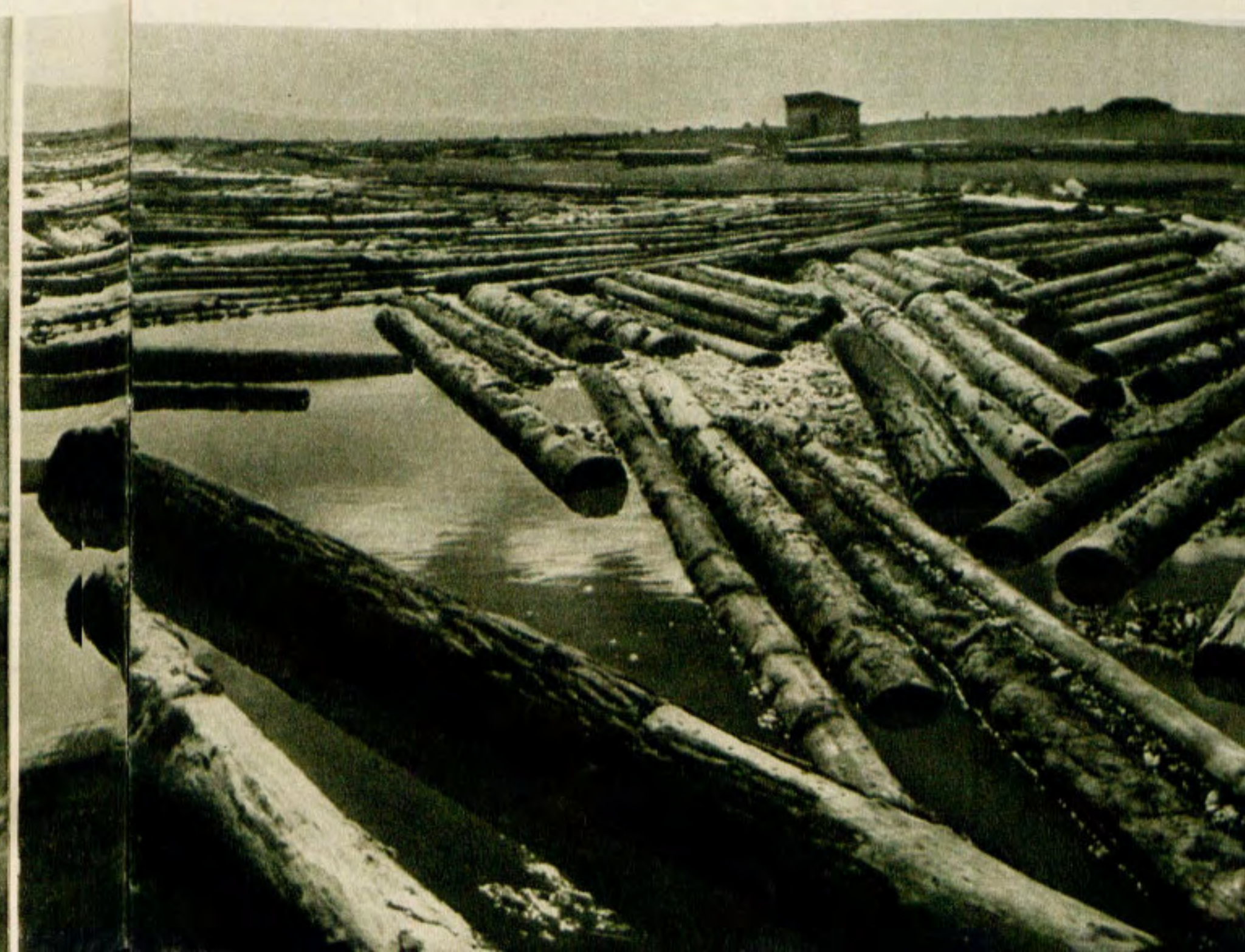
Абаканский деревообделочный комбинат. Подача конвейером бревен из бассейна к лесопильным рамам.
