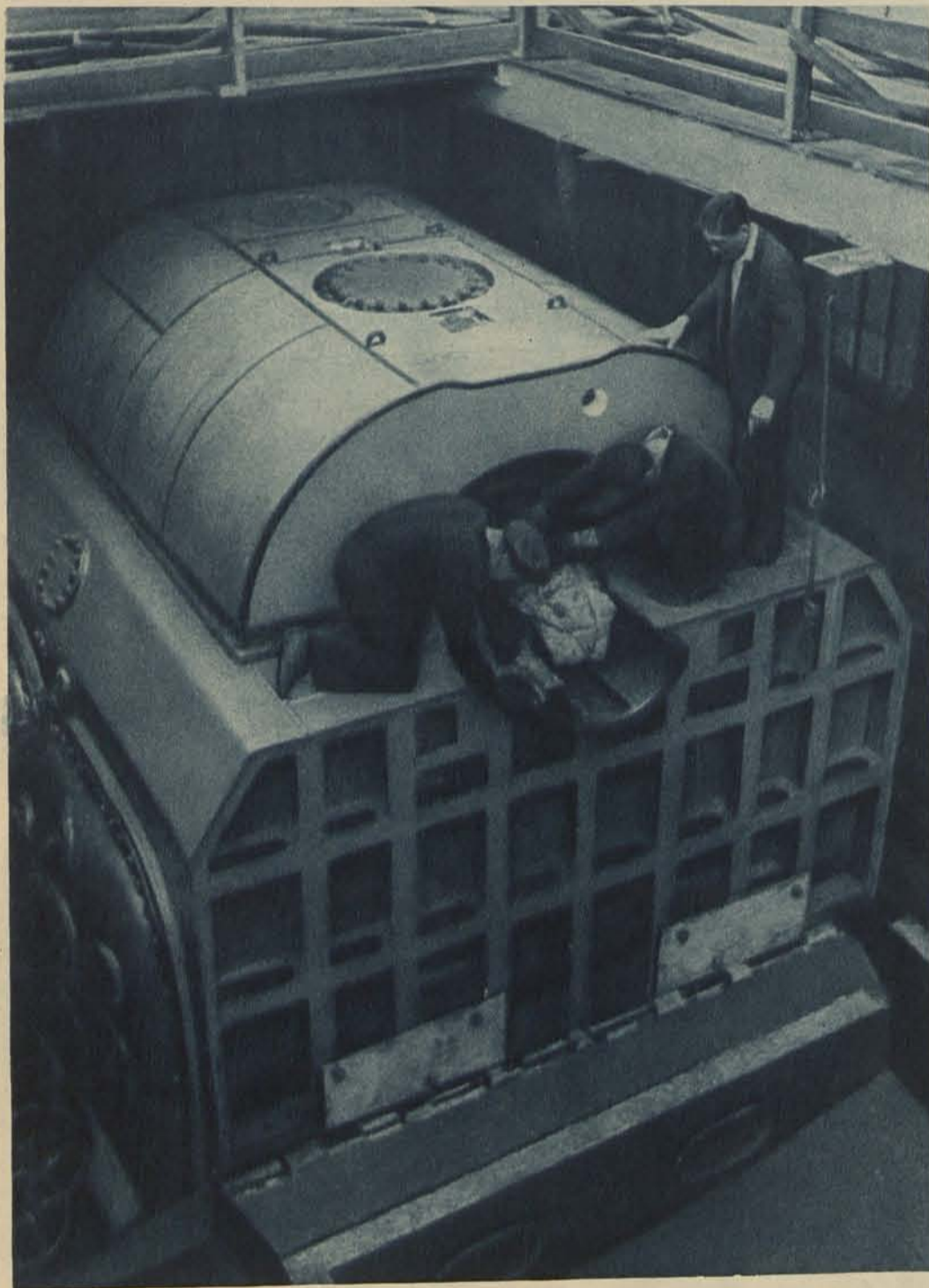
С особой точностью устанавливают многотонные суставы коленчатого вала.
