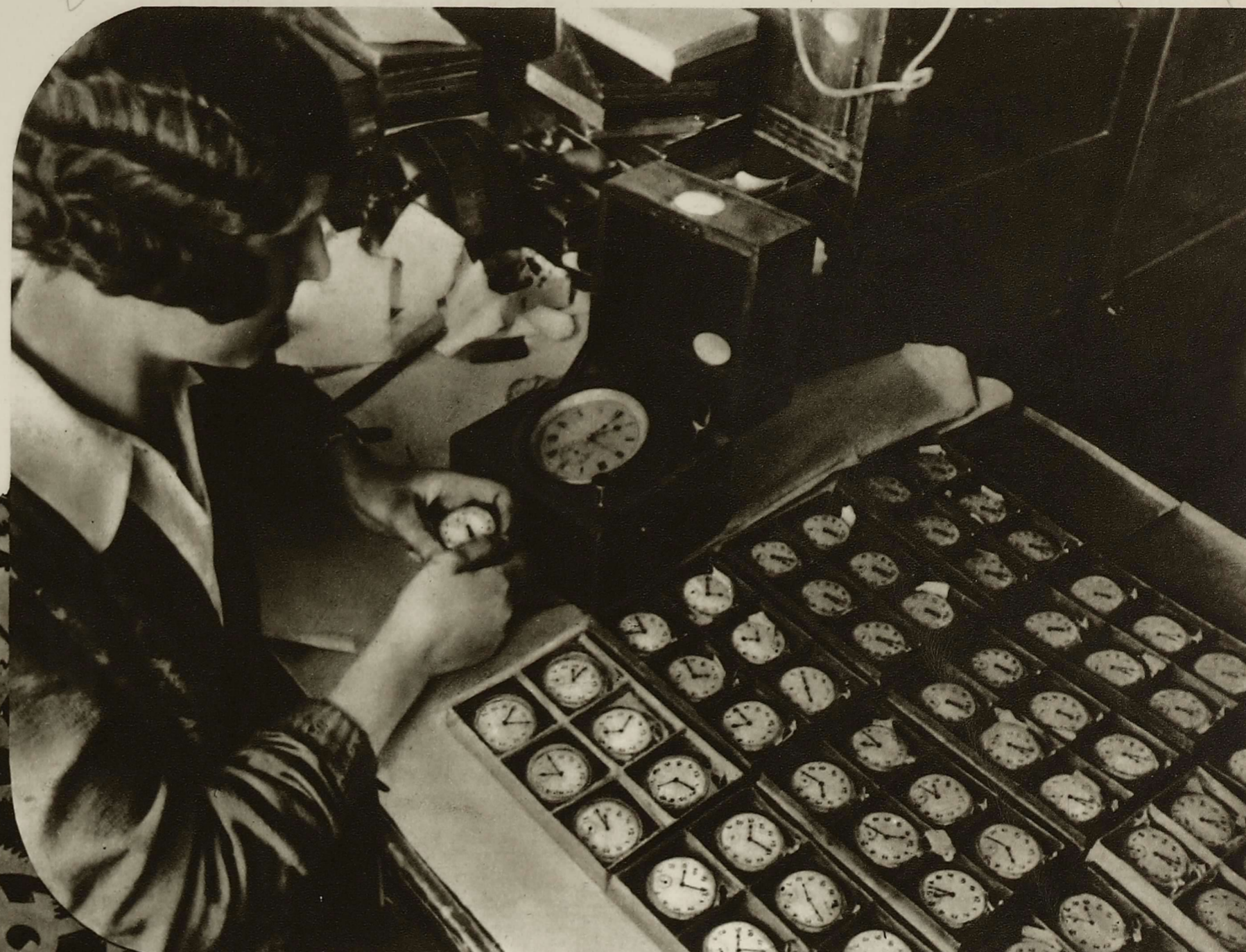
ПРОВЕРКА ГОТОВЫХ РУЧНЫХ ЧАСОВ ПО ХРОНОМЕТРУ.
