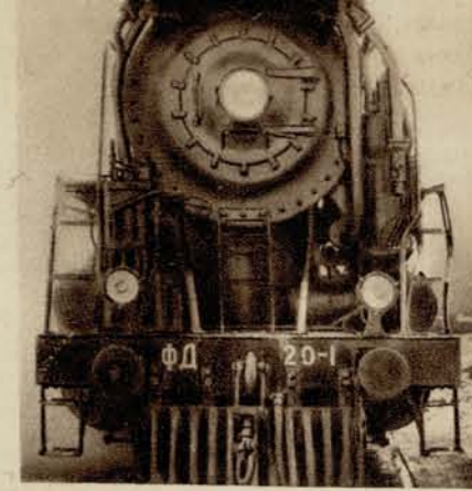
Первенец мощного советского паровозостроения — паровоз ФД 1-5-1 на заводских путях Луганского завода.
