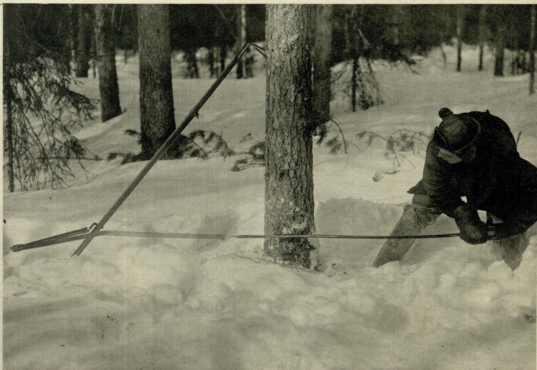
ЕЩЕ БОЛЕЕ СОВЕРШЕННЫЙ СПОСОБ ВАЛКИ—ПРУЖИННОЙ ПИЛОЙ (ПЛЕСЕЦКИЙ РАЙОН)
