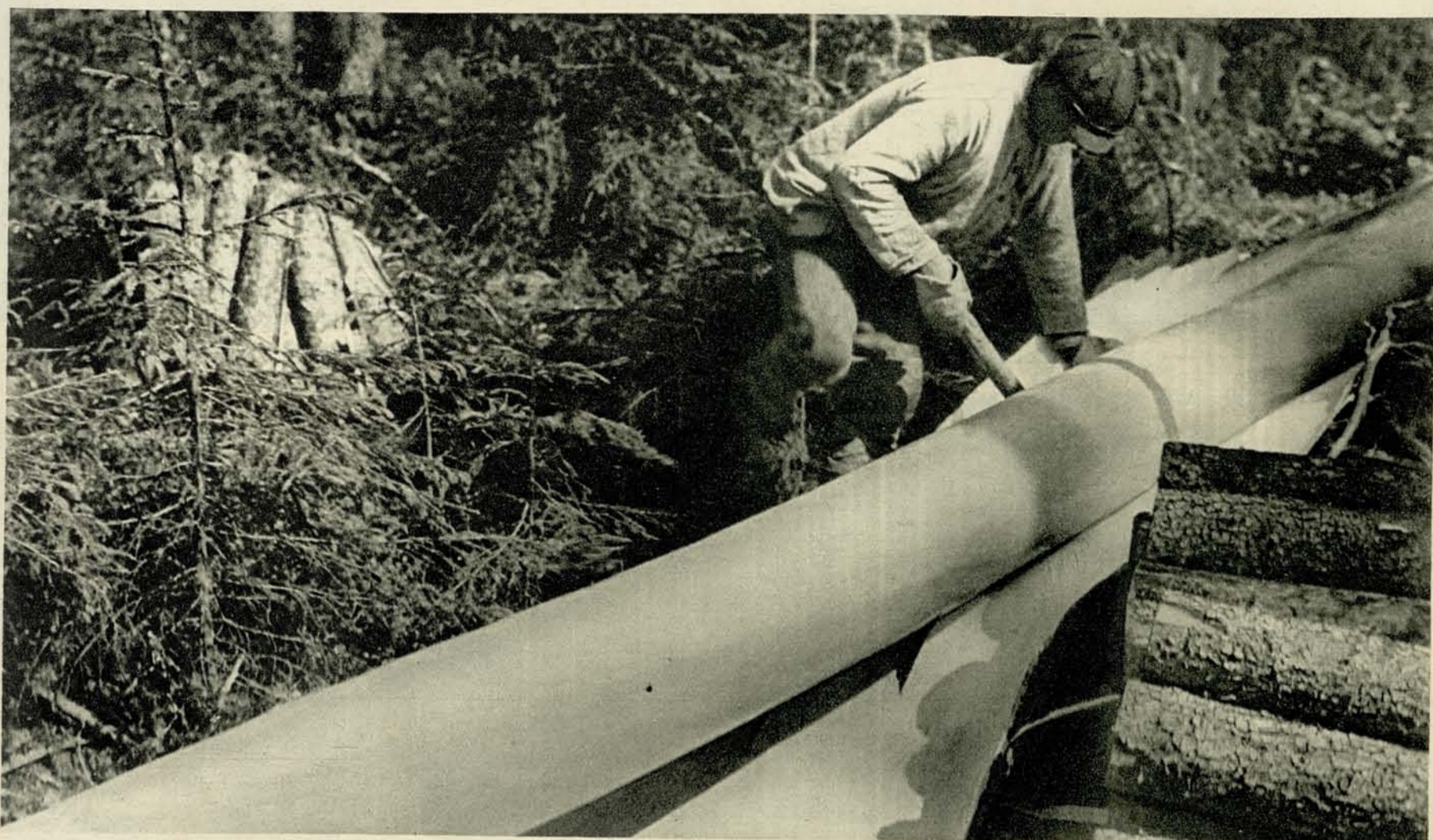
ДЕРЕВО ПОСТУПАЕТ В ОКОРКУ (ОСОЧКУ). КОРА ИСПОЛЬЗУЕТСЯ КОЖЕВЕННОЙ ПРОМЫШЛЕННОСТЬЮ В КАЧЕСТВЕ ДУБИЛЬНОГО ВЕЩЕСТВА
