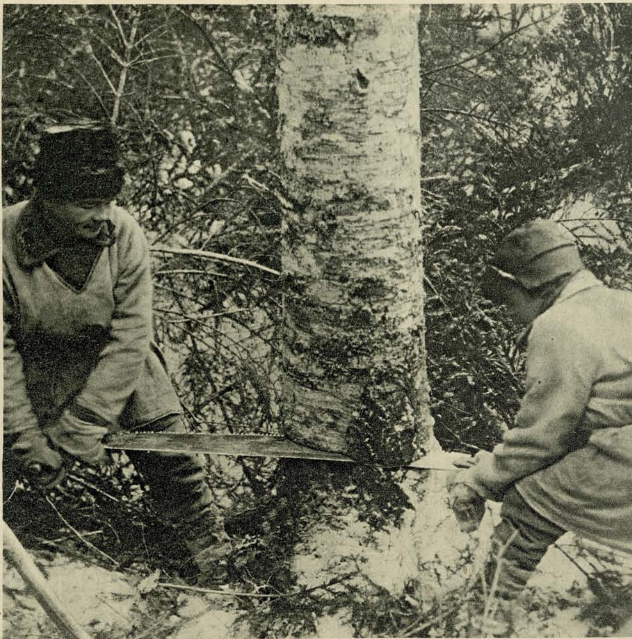
БОЛЕЕ СОВЕРШЕННЫЙ СПОСОБ ВАЛКИ ЛЕСА—СПИЛИВАНЬЕМ (КРАСНОБОРСКИЙ ЛЕСПРОМХОЗ СЕВКРАЯ)
