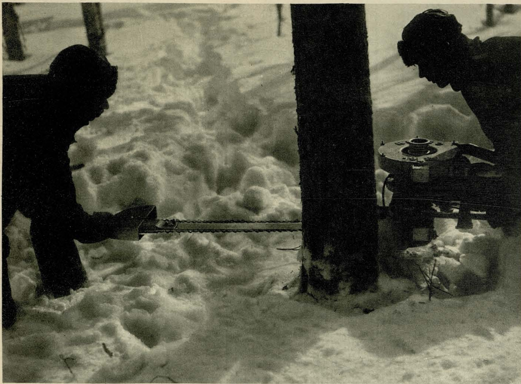
МЕХАНИЗАЦИЯ ВТОРГАЕТСЯ В ЛЕСА: ВАЛКА МОТОРНОЙ ПИЛОЙ (ПЛЕСЕЦКИЙ РАЙОН)—УСКОРЯЕТ РАБОТУ И ЭКОНОМИТ ЧЕЛОВЕЧЕСКИЙ ТРУД ФОТО М. АЛЬПЕРТА
