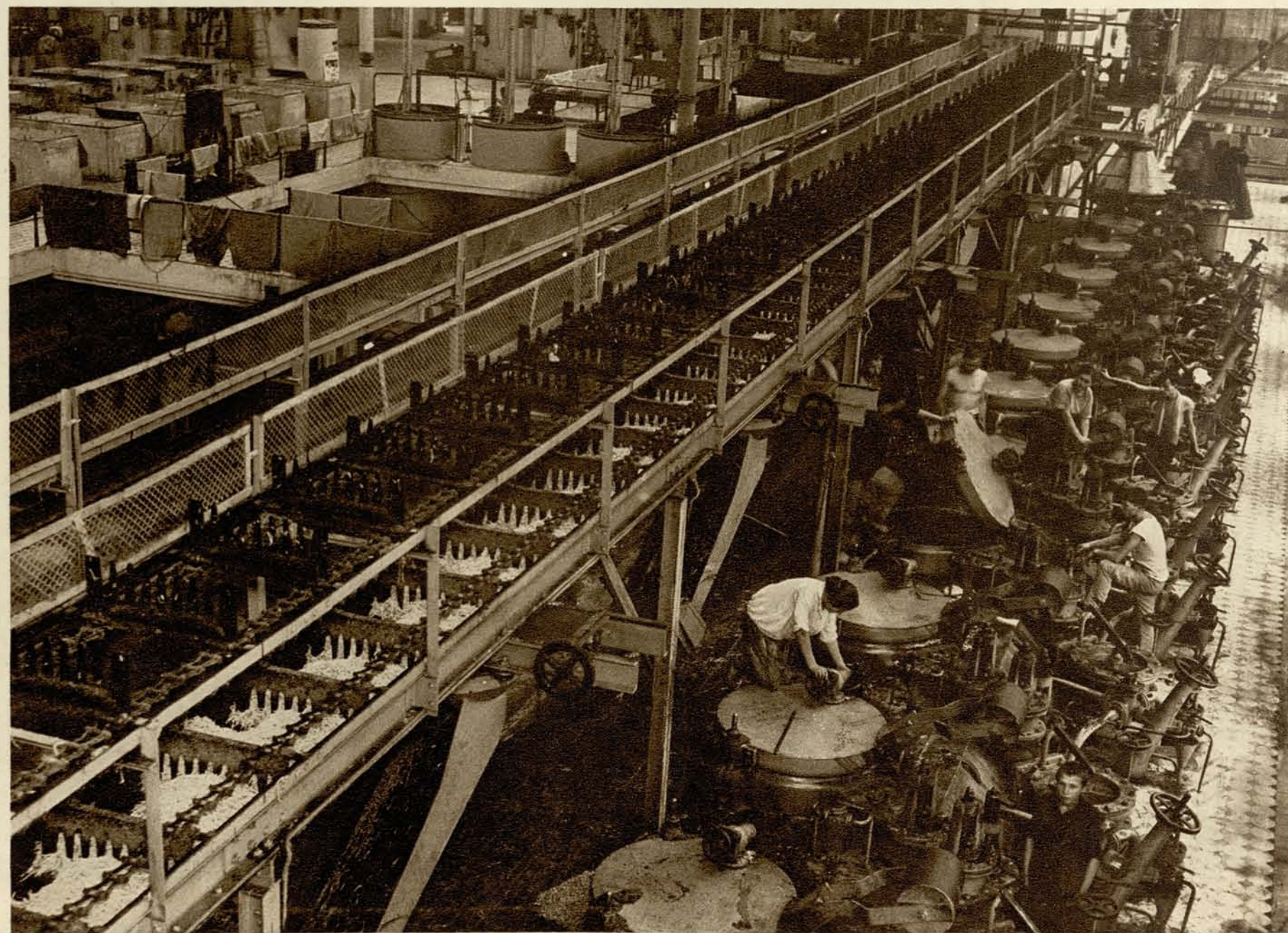
ИЗМЕЛЬЧЕННАЯ СВЕКЛА НАПРАВЛЯЕТСЯ ТРАНСПОРТЕРОМ В ДИФФУЗОР ДЛЯ ИЗВЛЕЧЕНИЯ ПЕРВИЧНОГО САХАРНОГО СОКА
