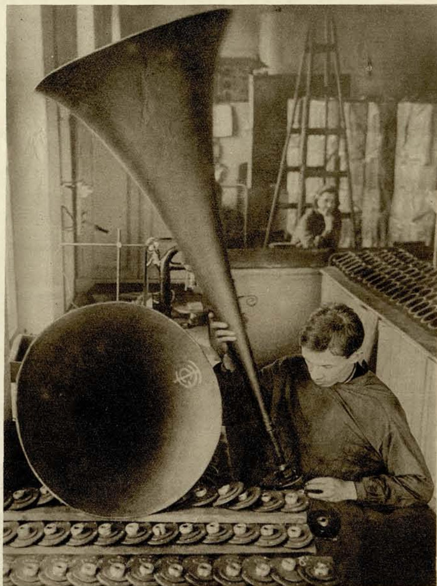
СБОРКА УЛИЧНЫХ РЕПРОДУКТОРОВ НА ЗАВОДЕ ИМЕНИ КУЛАКОВА
