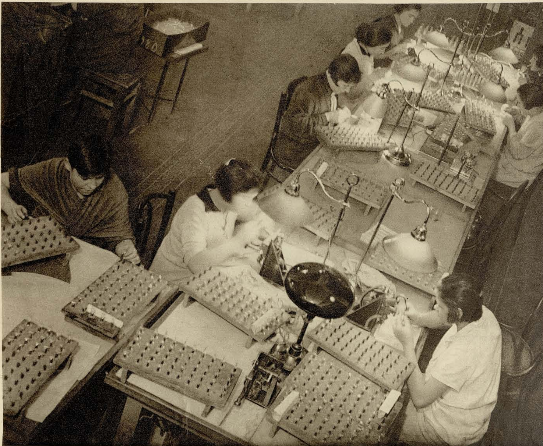
МОНТАЖ УСИЛИТЕЛЬНЫХ ЛАМП
