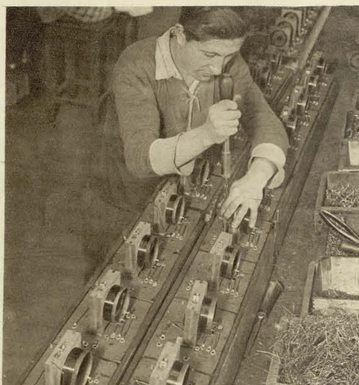
СБОРКА РАДИОПРИЕМНИКОВ НА КОНВЕЙЕРЕ
