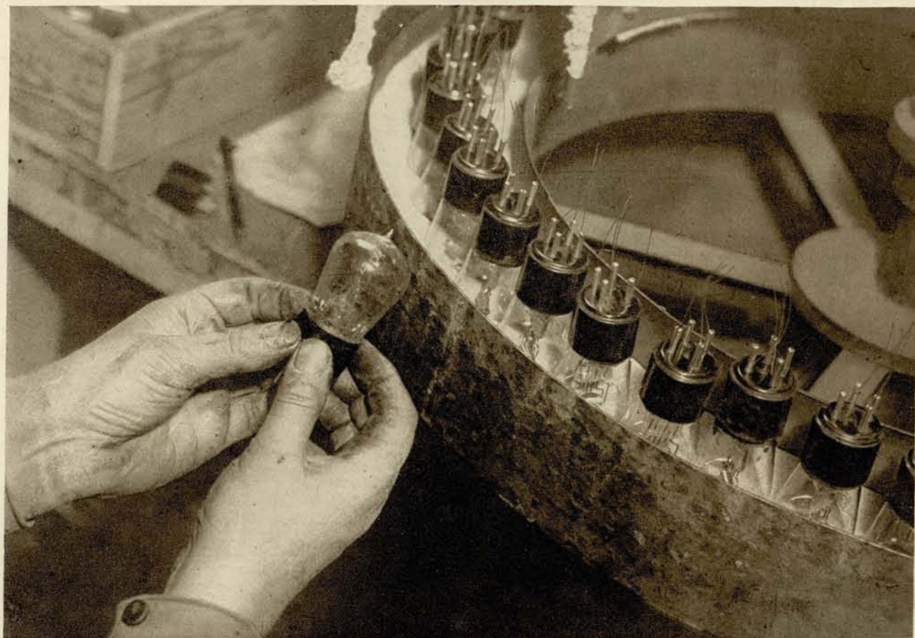
ЦОКОЛЕВКА УСИЛИТЕЛЬНЫХ ЛАМП
