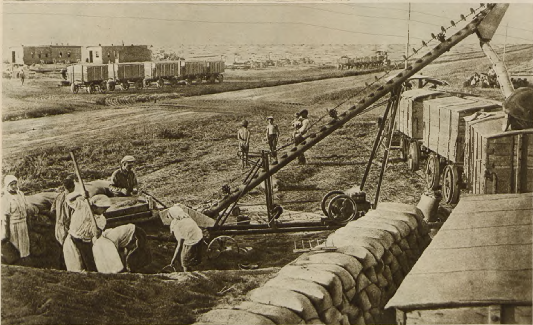
ПОГРУЗКА ЗЕРНА В ЗЕРНОВОЗКИ ПЕРЕГРУЖАТЕЛЕМ «ДЖОН-ДИР» (ВМЕСТИМОСТЬ КАЖДОЙ ЗЕРНОВОЗКИ — 3 ТОННЫ)
