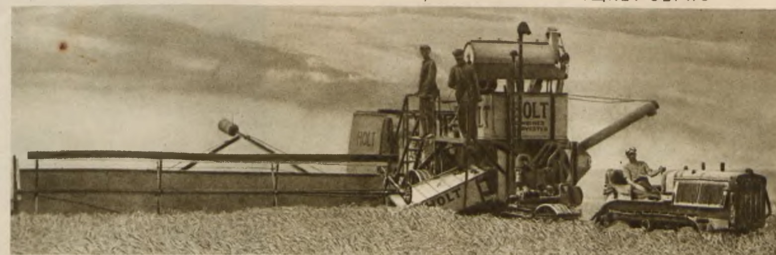
СВЫШЕ ДВУХСОТ КОМБАЙНОВ РАБОТАЮТ НА ПОЛЯХ «ГИГАНТА». РАБОТАЯ В ДВЕ СМЕНЫ, КОМБАЙН ОБРАБАТЫВАЕТ В СРЕДНЕМ 25 ГЕКТАРОВ В ДЕНЬ: ОН ЖНЕТ, МОЛОТИТ И ОЧИЩАЕТ ЗЕРНО
