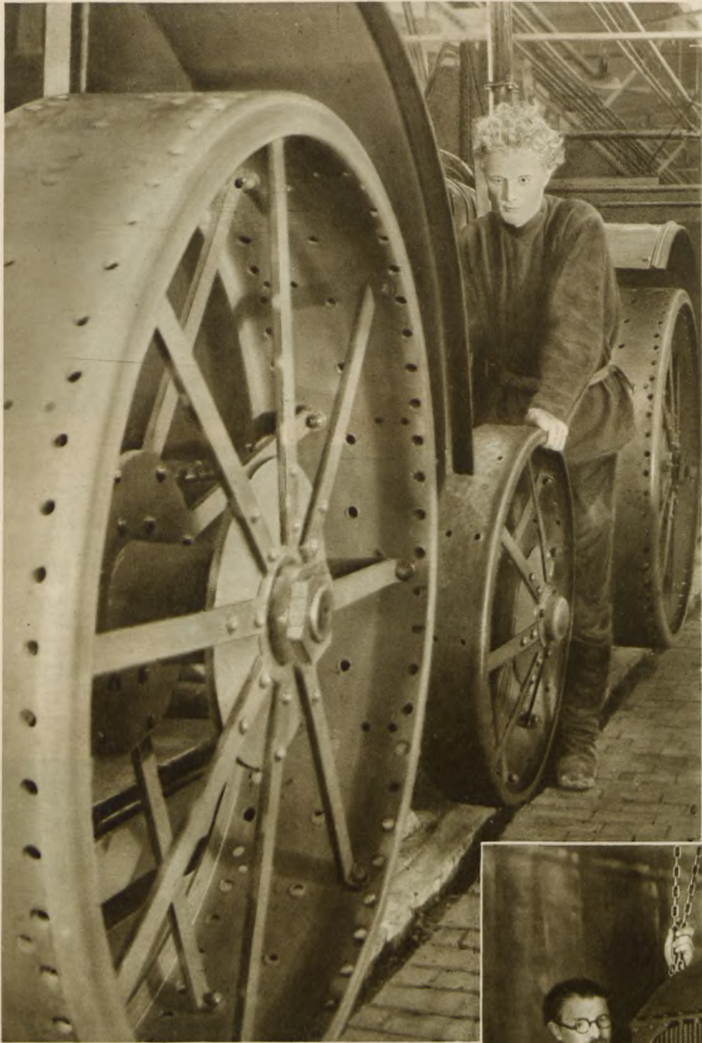
ПРИГОНКА ПЕРЕДНЕГО КОЛЕСА ТРАКТОРА НА КОНВЕЙЕРЕ
