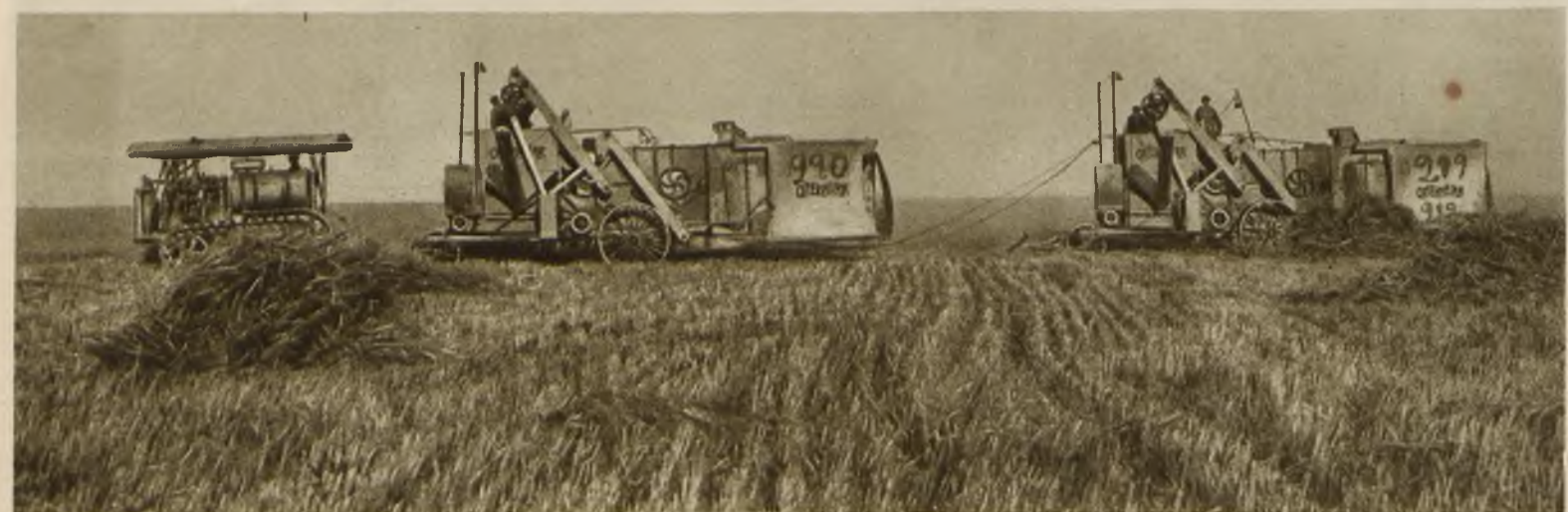
СВЫШЕ ДВУХСОТ КОМБАЙНОВ РАБОТАЮТ НА ПОЛЯХ «ГИГАНТА». РАБОТАЯ В ДВЕ СМЕНЫ, КОМБАЙН ОБРАБАТЫВАЕТ В СРЕДНЕМ 25 ГЕКТАРОВ В ДЕНЬ: ОН ЖНЕТ, МОЛОТИТ И ОЧИЩАЕТ ЗЕРНО
