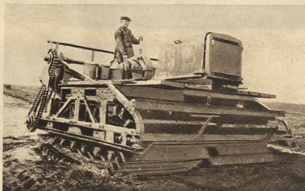
ТРАКТОР-ГУСЕНИЦА ФОРМУЕТ В КИРПИЧИ ГИДРОМАССУ («ЖИД- КИЙ ТОРФ») НА ПОЛЯХ РАЗЛИВА
