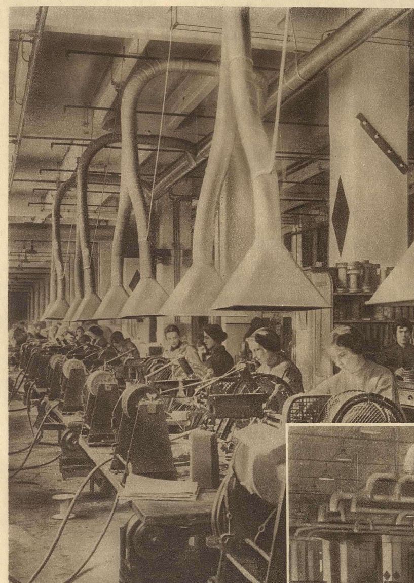
ОБМОТОЧНЫЙ ЦЕХ ТРАНСФОРМАТОРНОГО ОТДЕЛА, ГДЕ ИЗГОТОВЛЯЮТСЯ КАТУШКИ ДЛЯ ТРАНСФОРМАТОРОВ МАЛОЙ МОЩНОСТИ
