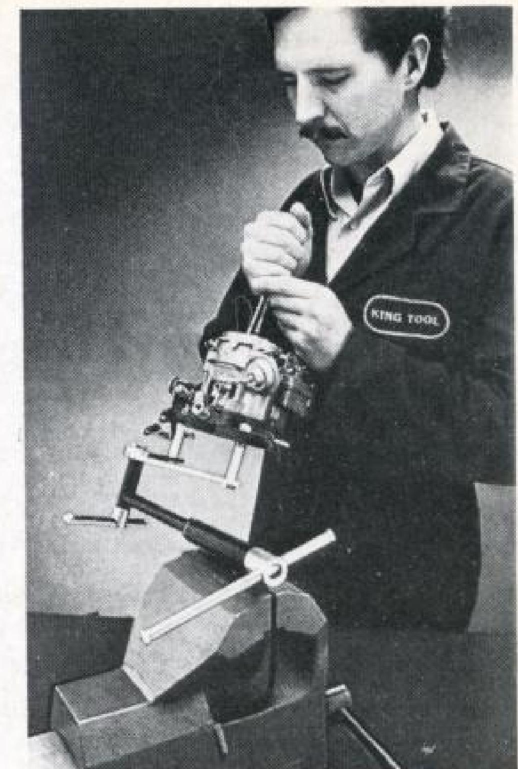
**Универсальную комбинированную струбцину-кронштейн, позволяющую удобно расположить над тисками различные агрегаты: карбюраторы, генераторы, кондиционеры и т. п. (и освободить обе руки) предлагает фирма King Tool (США).**
