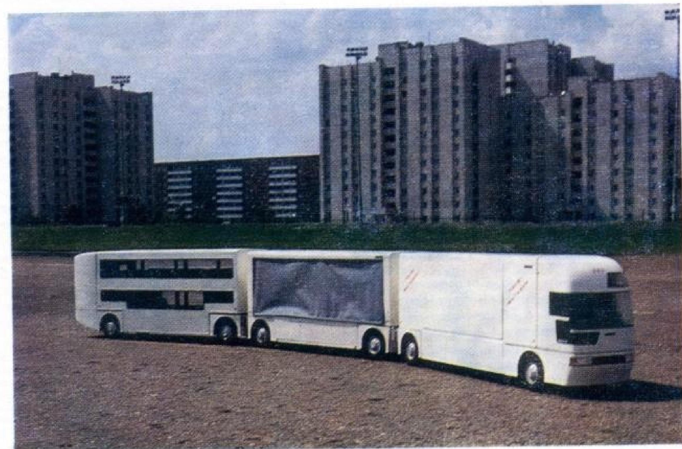
1. Основные модули для формирования двух- и трехзвенных автопоездов: одноосный тягач, двухосная моторная тележка, грузовой фургон, двухэтажный автобусный кузов с задним бытовым блоком-обтекателем, грузовой фургон с боковыми пологами
