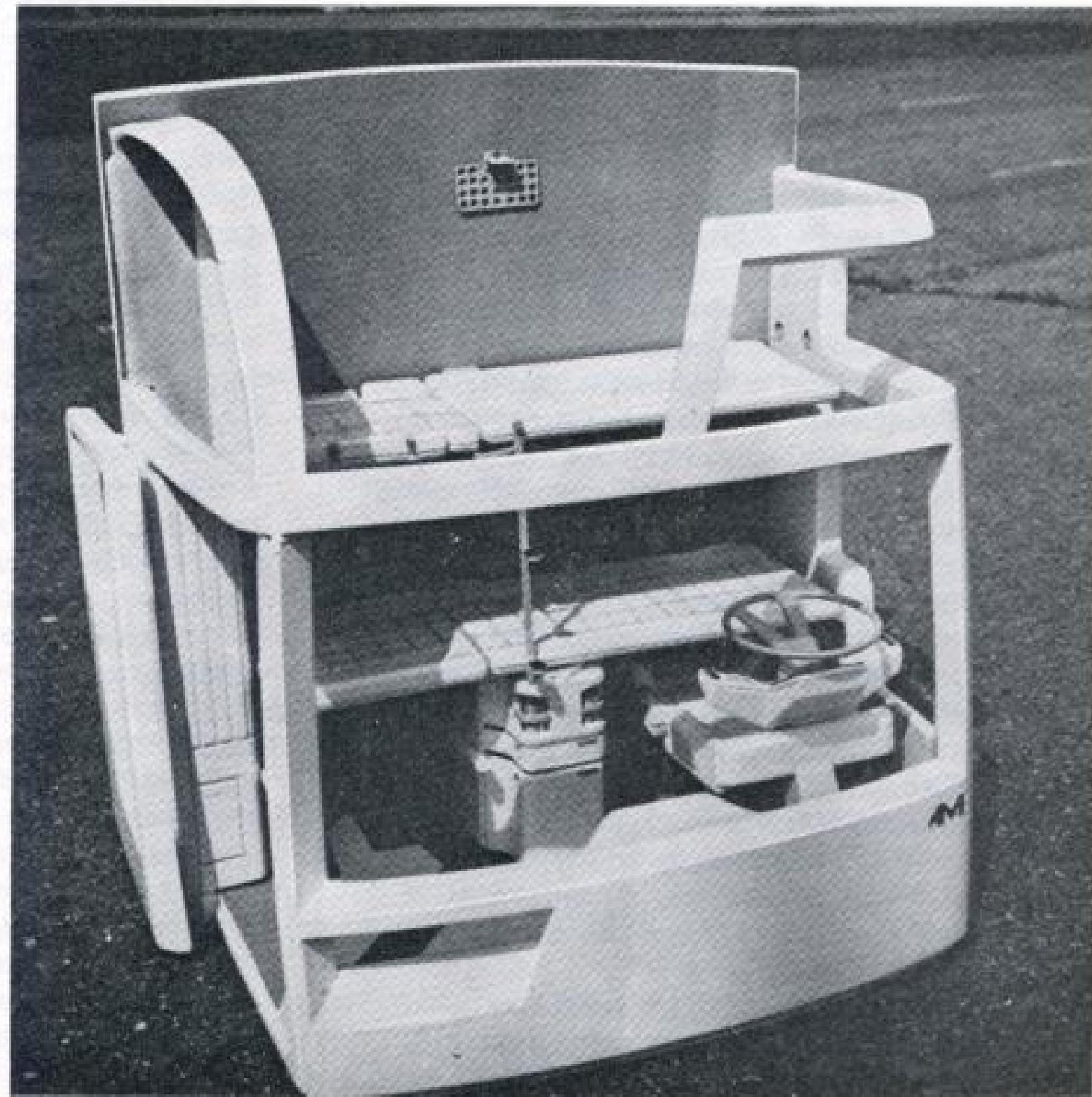
мотрен кухонный блок и два трансформируемых спальных места. Такая кабина рассчитана на водителя и сменщика и предназначена для установки на автомобили дальних рейсов.
