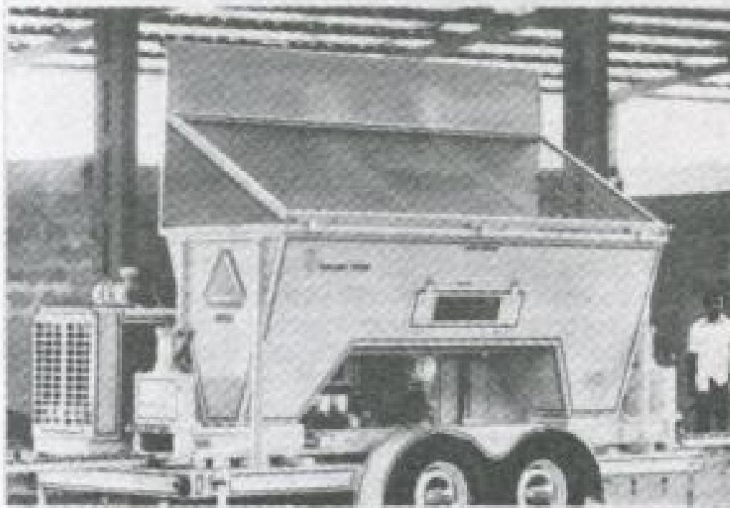
**Машину, вырабатывающую строительные кирпичи,** спроектировал и построил инженер NASA Роберт В. Гросс (США). Кирпичи размером 30×25×9 см образуются путем прессования сырой земли без добавок под высоким давлением более 30 МП. Производительность — 600 штук в час. Постройки ведутся без цемента или извести. Машина маневренна, управляет компьютером. Внешний уход за ней можно поручить неквалифицированным рабочим. В настоящее время строятся десятки тысяч домов с использованием этих машин.
