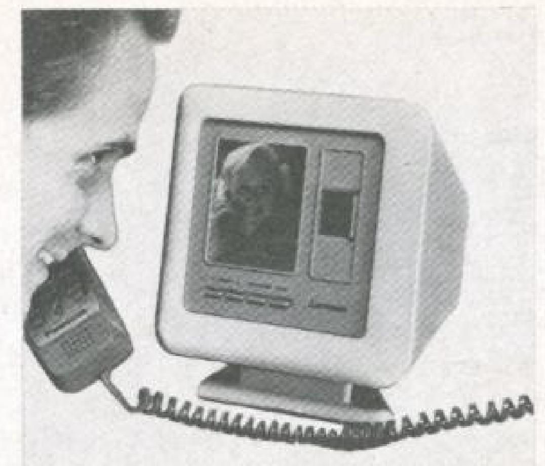
**Видеотелефоны** значительно подешевели и могут использоваться в обычной телефонной сети благодаря тому, что вместо непрерывно меняющегося изображения теперь передаются моментальные снимки, следующие один за другим с интервалом в 5—10 секунд. Необходимые дополнительные электронные устройства миниатюрны и занимают мало места. Телефоны такого рода выпускаются фирмой Sony (Япония), ряд других японских фирм готовится выпускать видеотелефоны, в том числе и с цветным изображением.
