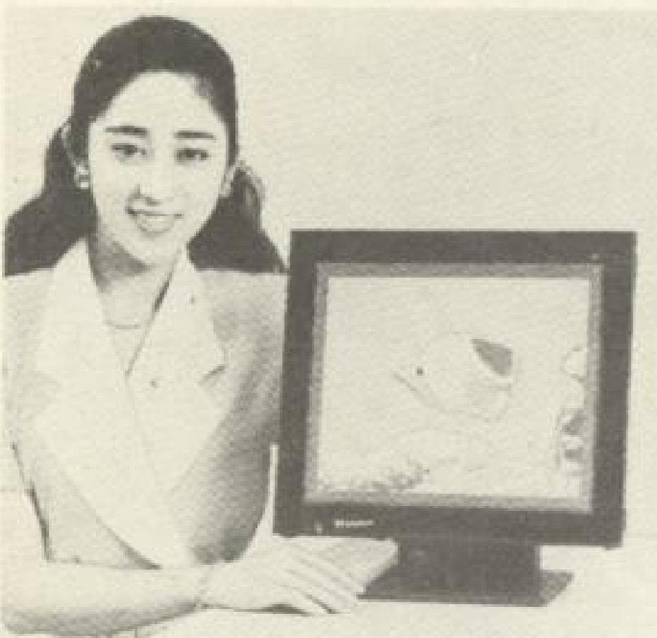
Самый большой на сегодня плоский цветной телевизор разработала японская фирма Sharp. Экран имеет размеры 278×221 мм и толщину 27 мм, включая заднее подсветное устройство. Он составлен из 1 232 640 элементов. Яркость 120 кд/м<sup>2</sup>, скорость реакции 17,5 мс. Углы бокового зрения — горизонтальные 60°, сверху 20°, снизу 30°.
