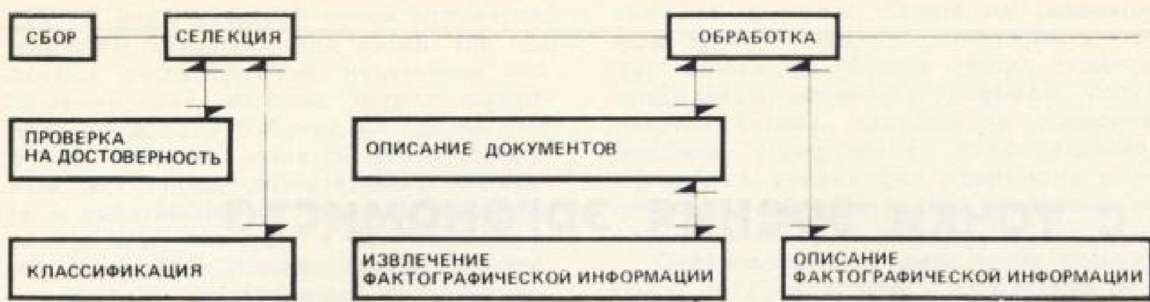
Блок-схема функционирования системы сбора информации
