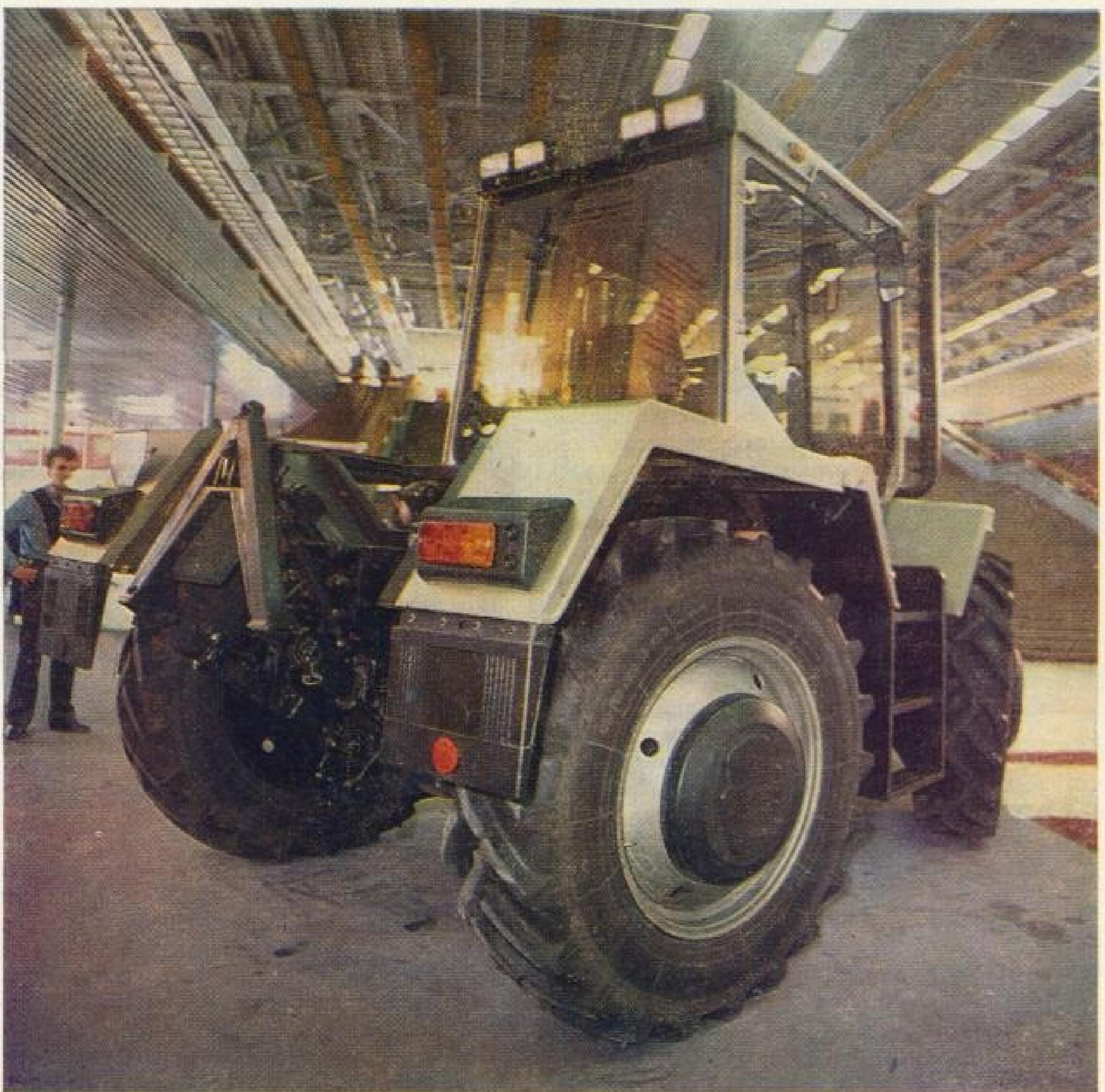
3. Отличительный элемент интегрально-го трактора — механизм передней на-вески перед моторной группой
