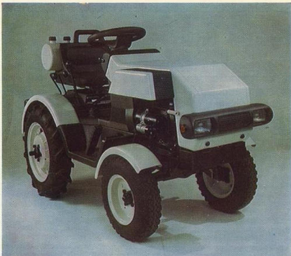
1, 2. Мيني-трактор «Сверчок» для приусадебных участков и небольших семейных ферм. Заказчик — ПО «Гомсельмаш» (г. Гомель). В дизайн-проекте значительно улучшены условия работы водителя, посадки и высадки, обзорность. Коренной переработке подверглись пульт управления, сиденье и все кузовные элементы.
