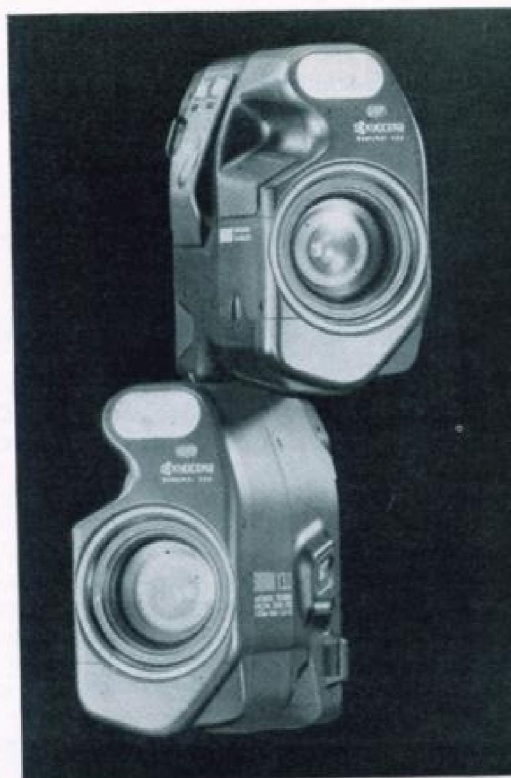
1. Однообъективный зеркальный 35-миллиметровый фотоаппарат Samourai фирмы Kyosera с ОПФ. Полный автомат. Объектив: 13 групп, 14 линз. Фокусное расстояние: 25—75 мм. Управление экспонированием: программный автомат. Диапазон экспозиций: EV1—EV18. Электронный затвор с диапазоном выдержек 2—1/500 с. Автоматическая транспортировка пленки. Габариты: 67×117×126 мм, вес 560 г. Дата выпуска 1987 г. Цена 59 800 иен
