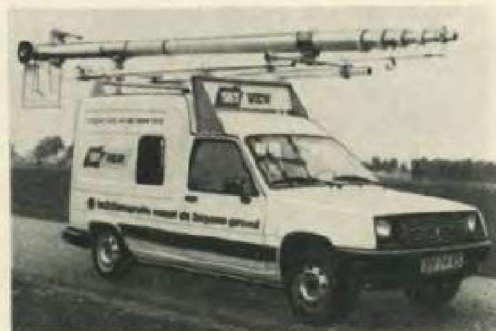
Выдвижная складная алюминиевая мачта на автомашине для производства снимков с высоты до 23 м предлагается фирмой Crown Andersen (США). Мачта имеет приспособление для нацеливания и фокусирования фотоаппарата с земли.
