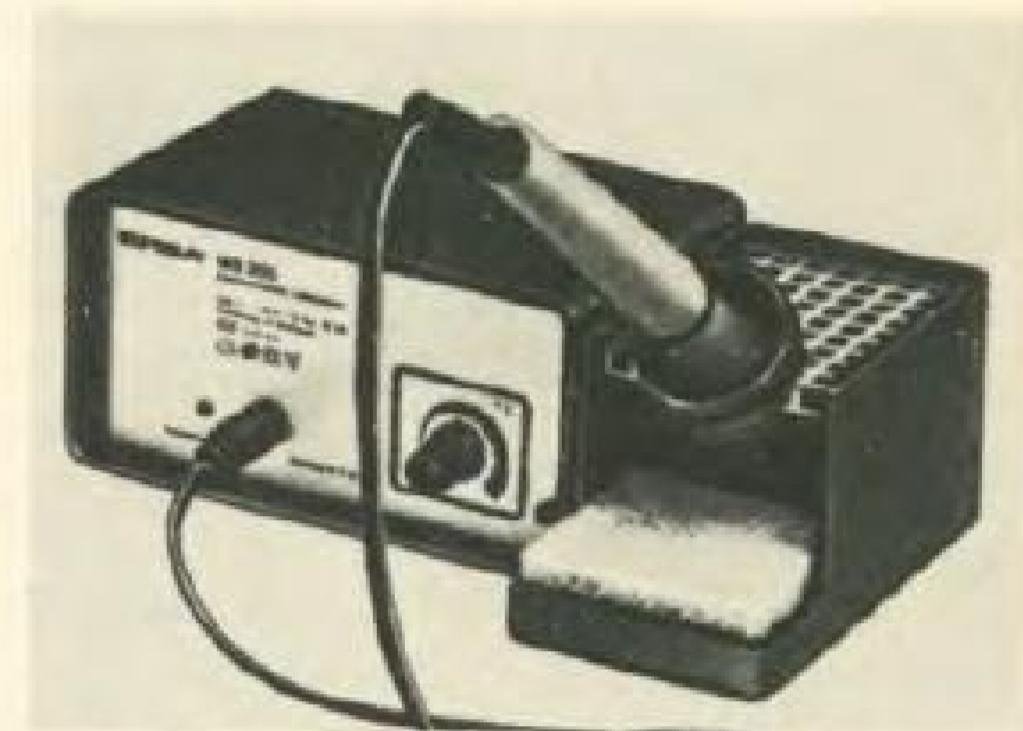
**Электропаяльный комбайн** максимальной мощности 25 Вт с электронным бесступенчатым управлением (по желанию), температурой паяющих наконечников от 70 до 430°C предлагает фирма EPTSA (ФРГ). 4 сменных наконечника, покрыты никелем или изготовленные из материала Long Life, быстро нагреваются изнутри. Однако это не препятствует их быстрой замене.
