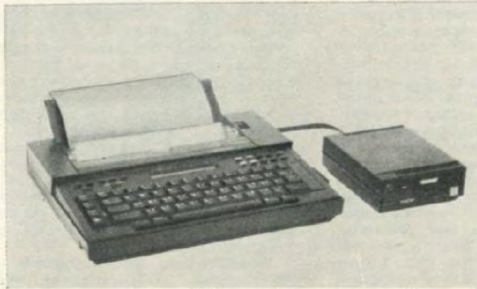
5. Телекоммуникационная система «ТС 6,00» содержит набор необходи- мых для редакторской работы устройств для передачи и принятия информации, обработки текста, запоминающее и печатающее устройства
