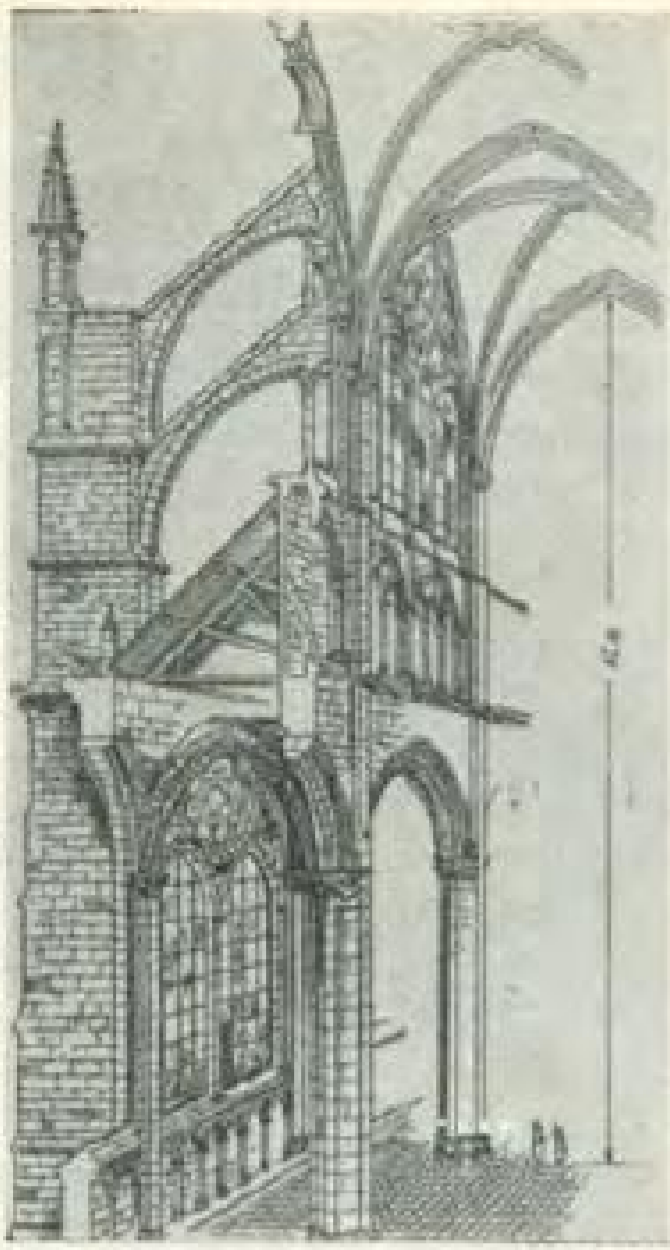
7. Схематический разрез готического собора [Амьен, XIII в.]
