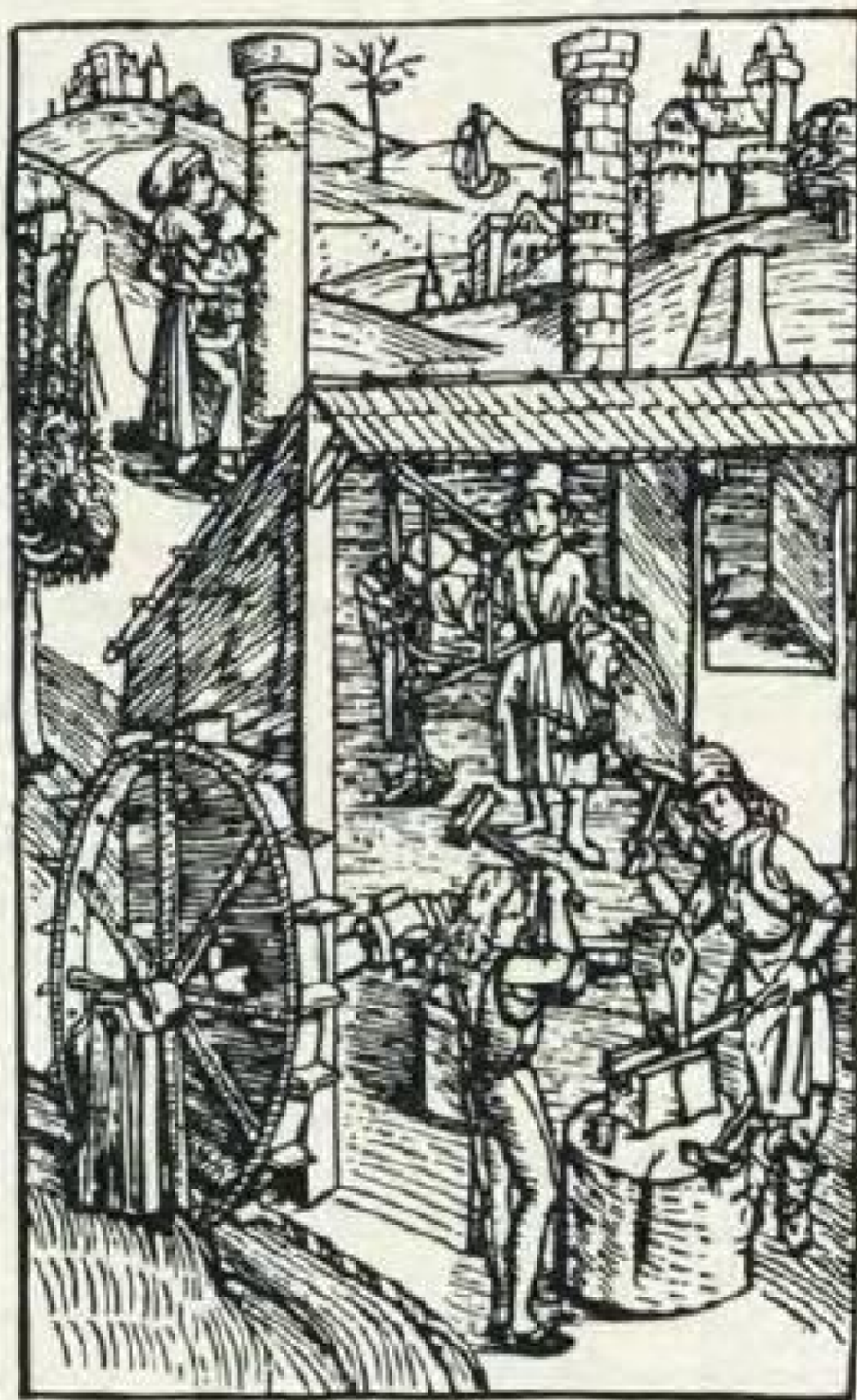
17. Кузница с приводом от водяного колеса [с гравюры XV в.]
