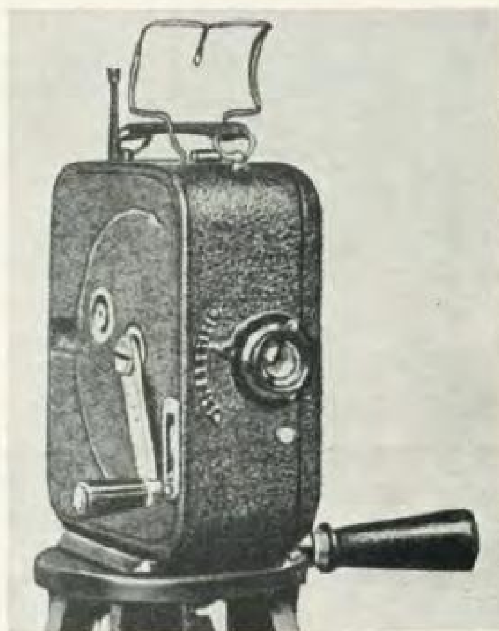
1. 35-мм фотокинокамера «Эрнест» мод. «С» фирмы Еггстапп, Германия, 10-е годы. Деревянный корпус, ручной привод, рамочный видоискатель, секторный затвор фотографического типа
