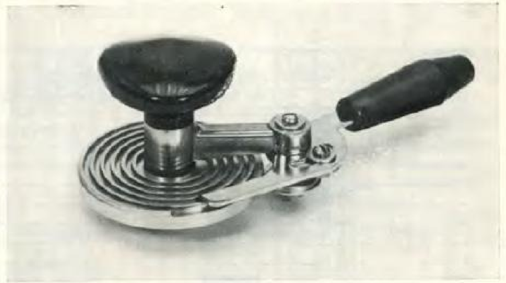
1, 2. Машинка закаточная полуавтоматическая МЗП-1 Житомирского завода станков-автоматов. Она имеет значительное количество деталей, что усложняет технологию производства изделия
