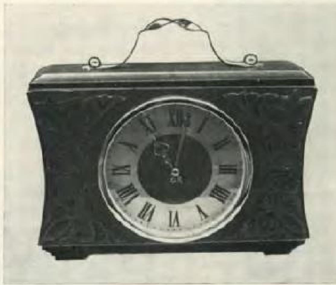
2. Модель 86 155/887 821. Корпус из фанеры, фанерован шпоном березы. Деревянные декоративные накладки ручной резьбы. Верхние и нижние планки корпуса из бука. Корпус лакированный. Циферблат латунный, поле обработано кольцевыми штрихами. Стрелки латунные, плоские, просечные. Стекло выпуклое, силикатное, ободок латунный. Габаритные размеры изделия 240×188×92 мм. Цена 35 руб.
