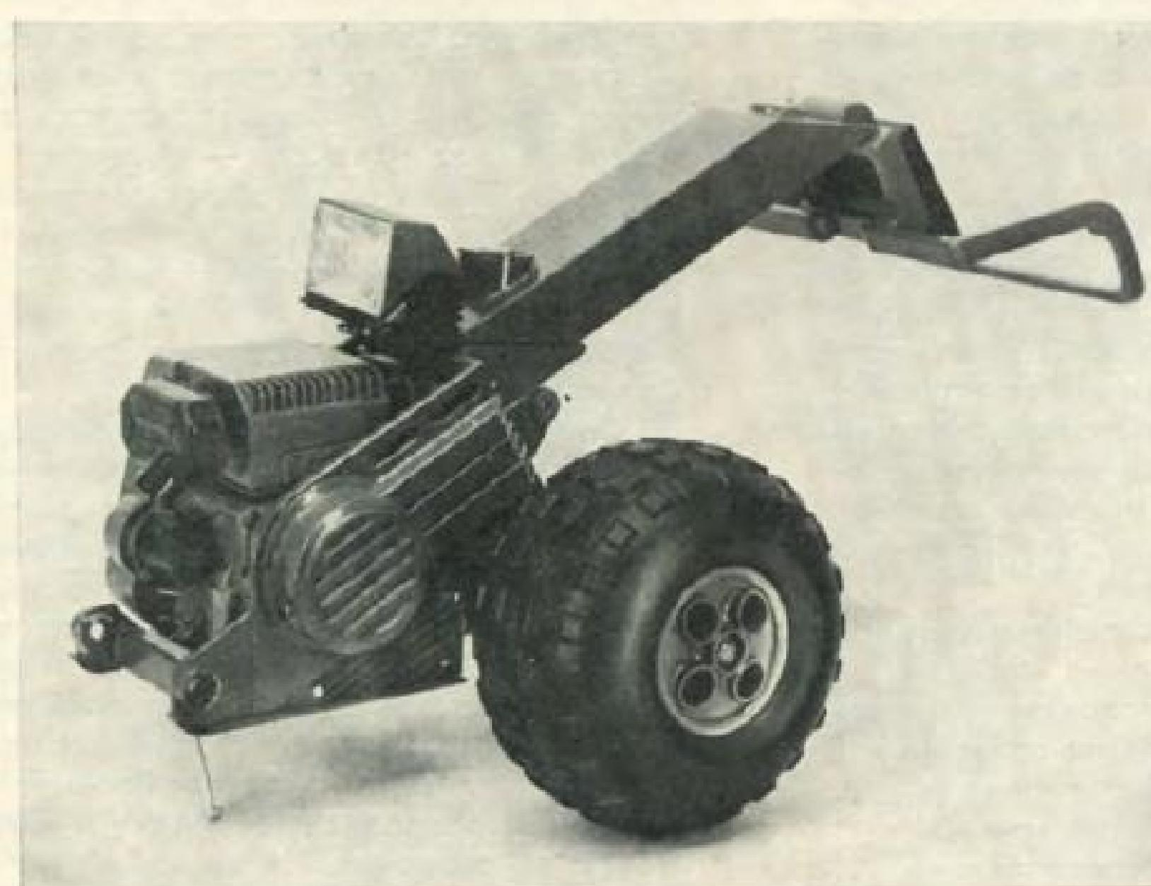
1—3. Изделия системы средств механизации, собираемых из элементов набора-конструктора: ездовой вездеход-трицикл с широкопрофильными шинами и шарнирной рамой, пешеходные микротракторы для работ на нормальном и переувлажненном грунте. Авторы дипломного проекта — С. В. ВЕРГУНОВ, В. С. ЛУКЬЯНЦЕВ, руководители — А. Н. КУШНЕРЕВИЧ, Е. Я. РАГУЛИН.
