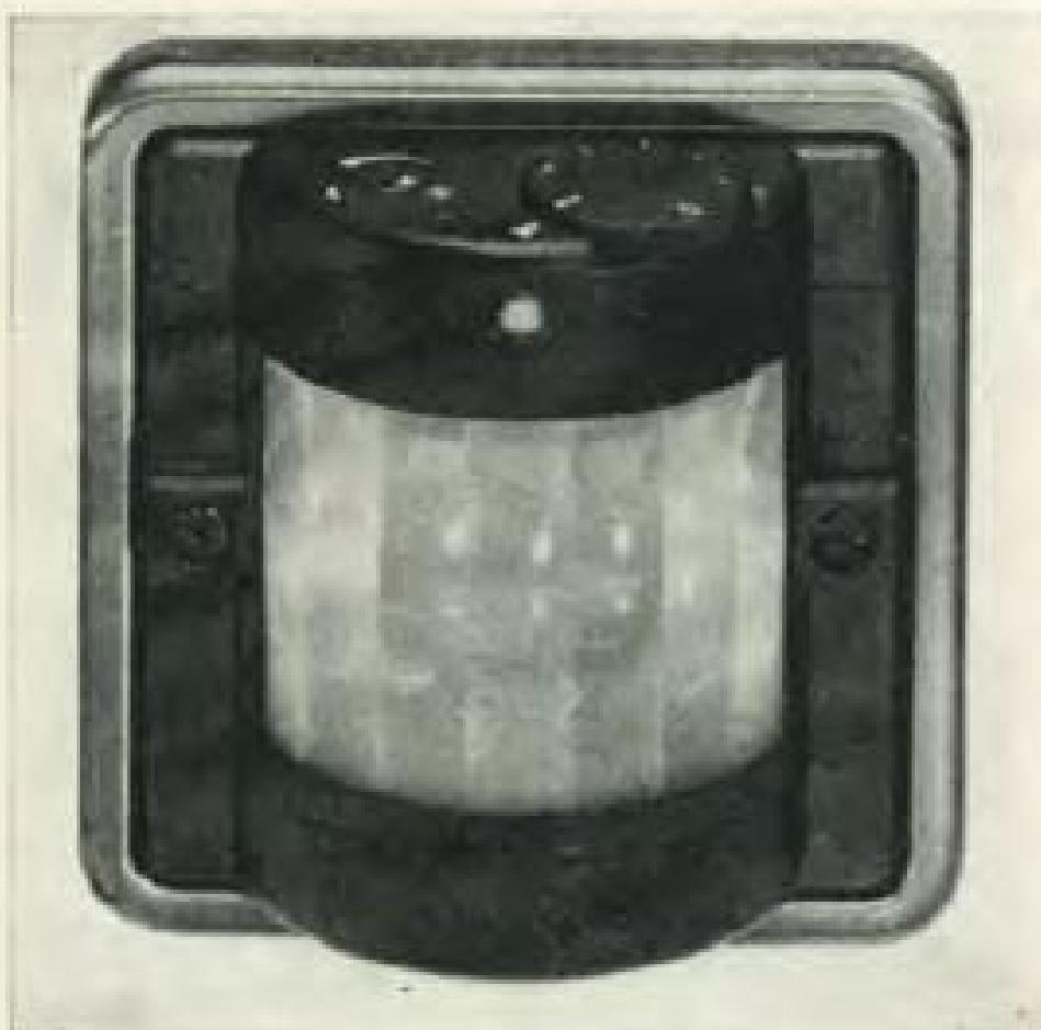
**Устройство, сигнализирующее о передвижении в его зоне обзора живых существ и предметов** (фирма Kipp, ФРГ), реагирует на исходящее от них инфракрасное излучение. Радиус действия 10 м. Пространственный угол обзора около  $8^{\circ}$ . Питание от сети напряжением 220 В. Устройство предназначено для охраны помещений и территорий и может быть приспособлено для автоматического включения-выключения осветительных приборов.
