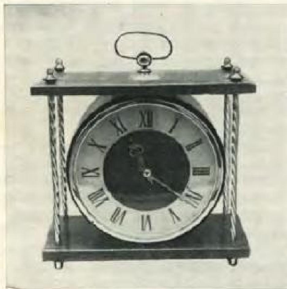
1. Модель 86 155/637 765. Цилиндрический корпус из фанеры или пластмассы. Верхняя и нижняя планки светлого или темно-коричневого цвета выполнены из фанеры, лакированы и полированы. Литые колонки, фигурные ножки и гайки, накладка и серьга ручки из латуни, полированы, лакированы. Циферблат из пластмассы покрыт эмалью цвета слоновой кости. Стрелки латунные, плоские, просечные. Стекло выпуклое, силикатное, ободок латунный. Габаритные размеры изделия 275×275×60 мм. Цена 24 руб.
