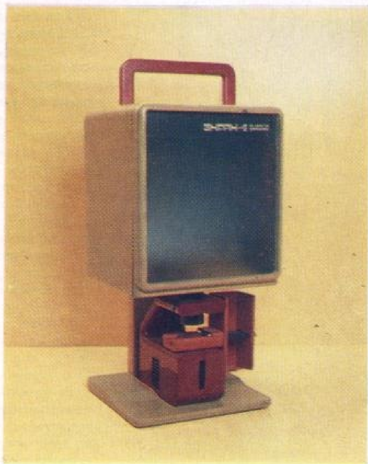
1. Днапроектор «Днарир-универсал» со встроенным экраном. Проецирует изображение на встроенный и выносной экраны. Упрощенная конструкция днамагазина не требует использования специальных кассет. Все операции по настройке изображения на выносном экране производятся с помощью специальной отклоняющей системы, которая исключает необходимость наклона и поворота самого днапроектора. Дизайнер А. В. ВЕРЕМЕЙЧУК
