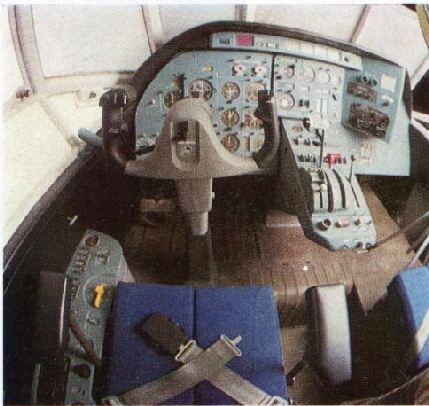
1. Общий вид кабины экипажа Ан-3 2. Конструкция кресел повысила безопасность пилотов при перегрузках
