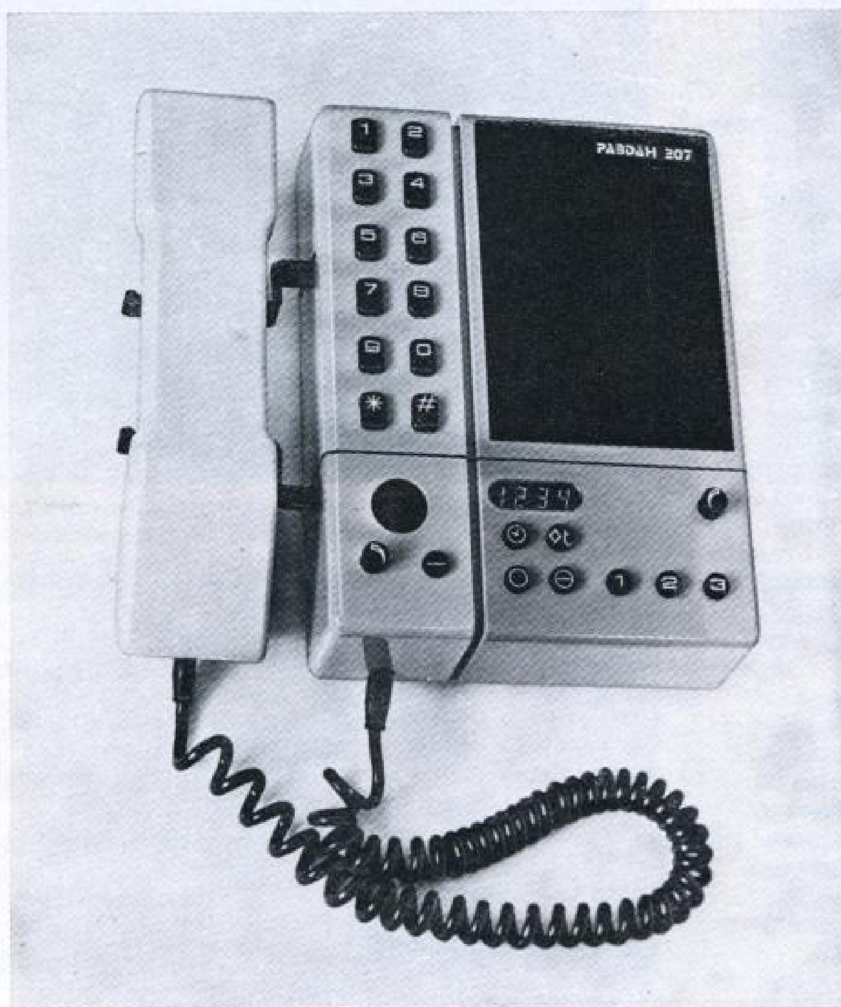
1—3. Бытовой информационный комплекс, состоящий из трехпрограммного громкоговорителя, таймера, телефона и микрофона
