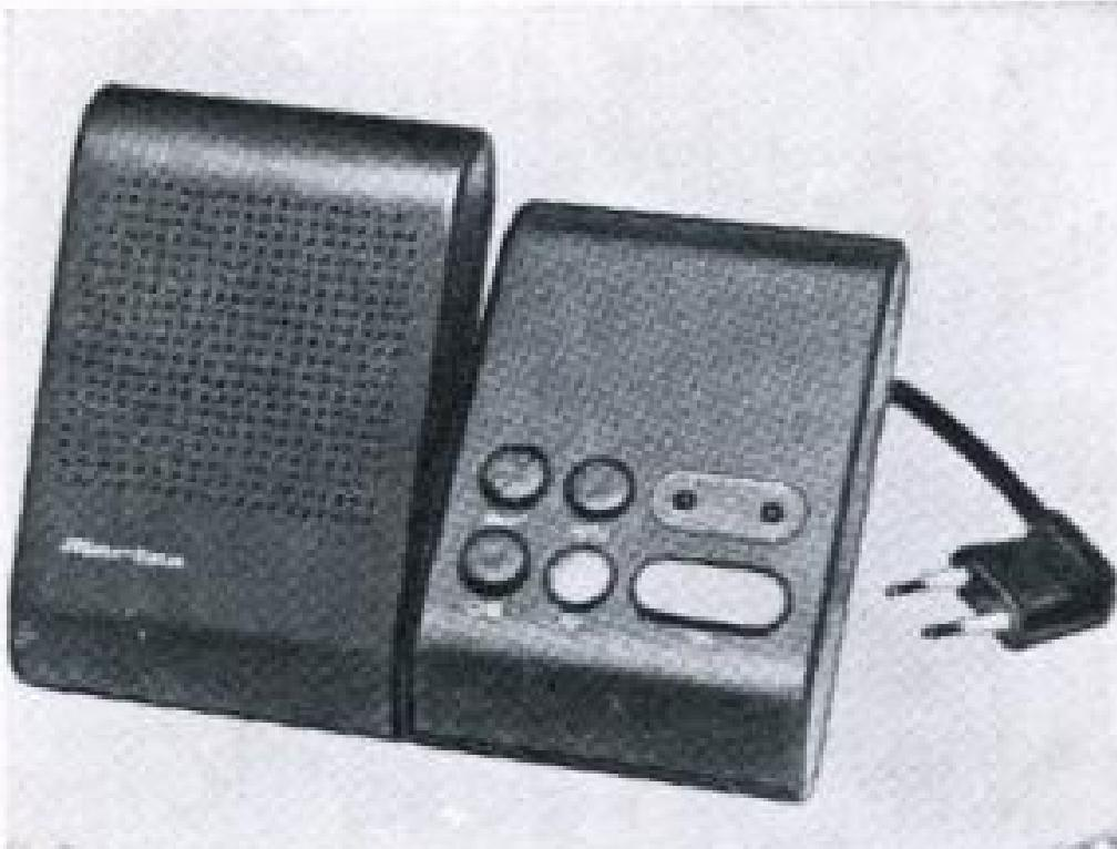
Переговорные устройства, использующие обычную осветительную электропроводку (фирма Merten, ФРГ), размещаются в разных комнатах одного здания. Каждый аппарат является передатчиком и громкоговорящим приемником. Переключение с передачи на прием — автоматическое и ручное. Последнее гарантирует конфиденциальность разговора.
