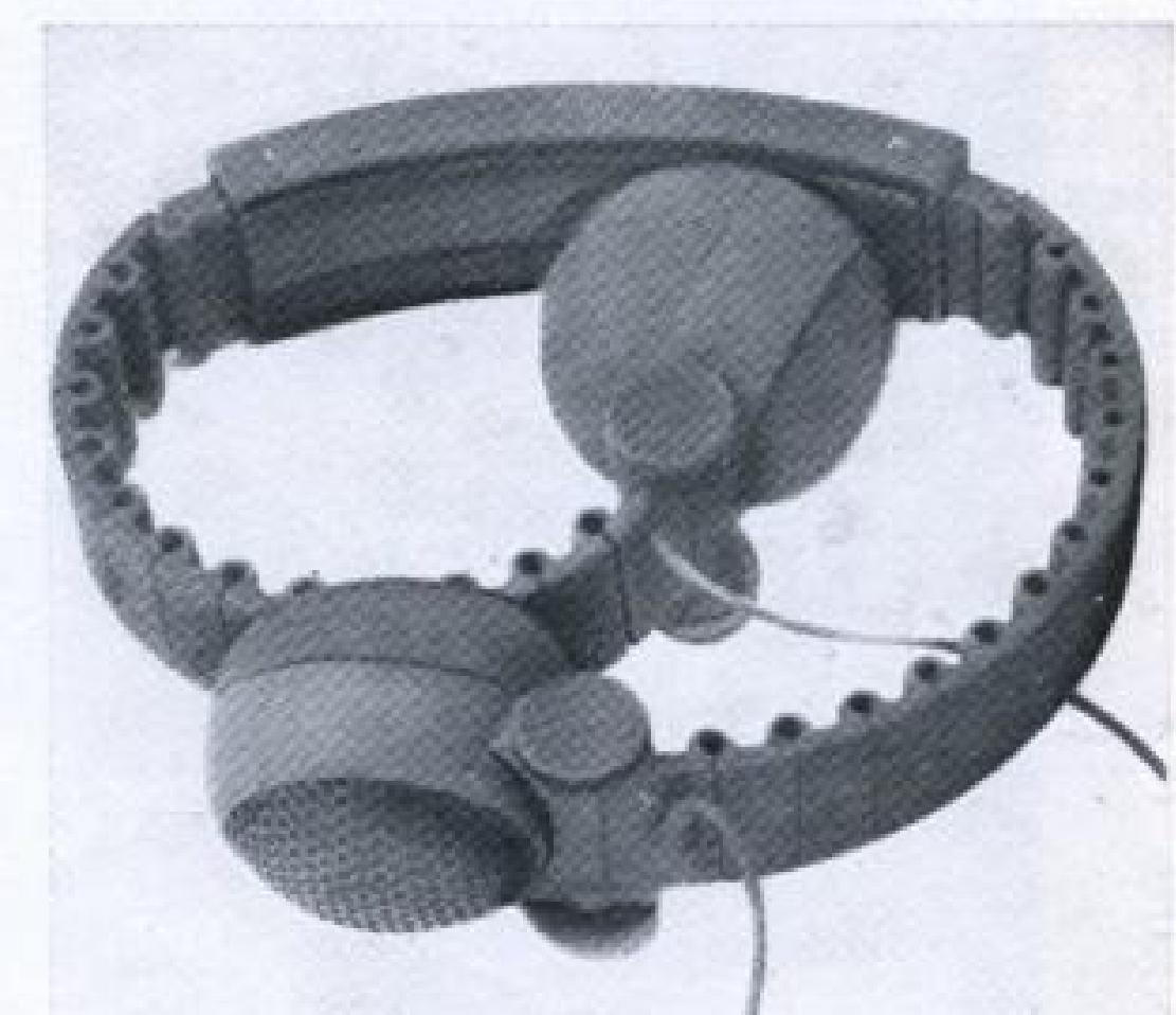
ная конструкция обеспечивает плотное мягкое прилегание оголовья и телефонов к голове и позволяет сворачивать оголовье, как бы заворачивая в него телефоны. Изделие в свернутом виде компактно и сохраняет приданную форму, что облегчает его транспортировку и хранение.
