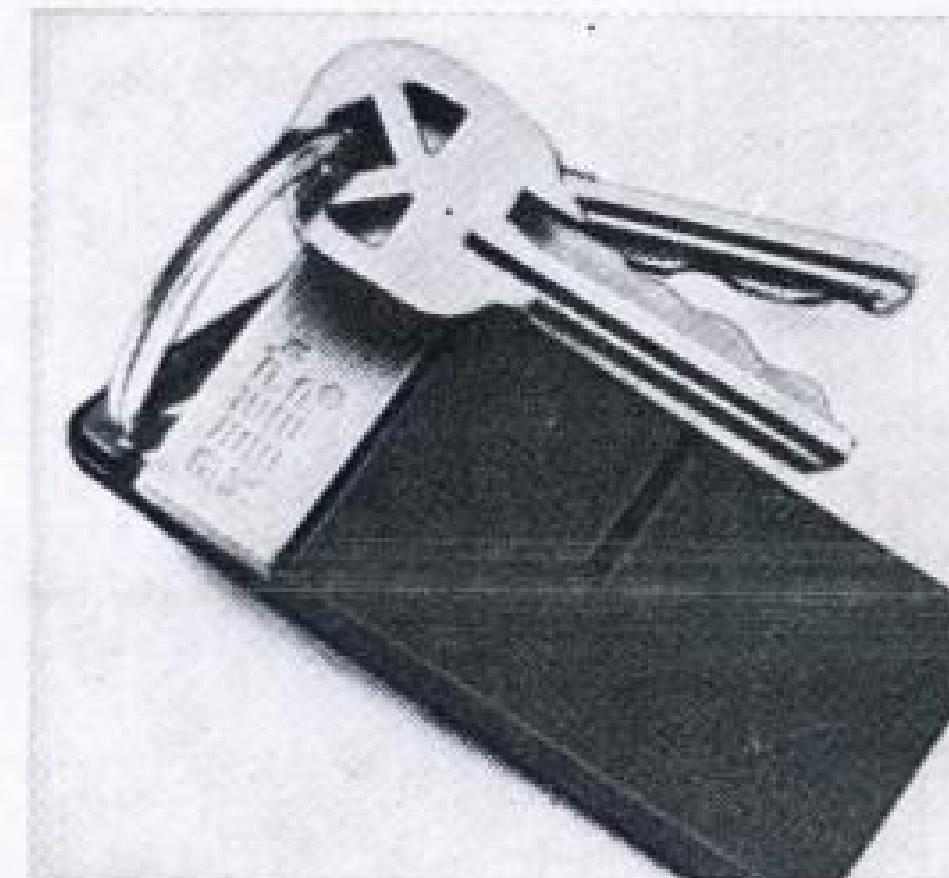
Мешочек для ключей со звуковой сигнализацией (фирма M. A. Bedol Catalogue, США) предназначен для лиц, постоянно теряющих свои ключи. Он начинает издавать чирикающие звуки, если 4 раза хлопнуть в ладоши или щелкнуть пальцами. Мешочек реагирует на звук в радиусе 10 м.
