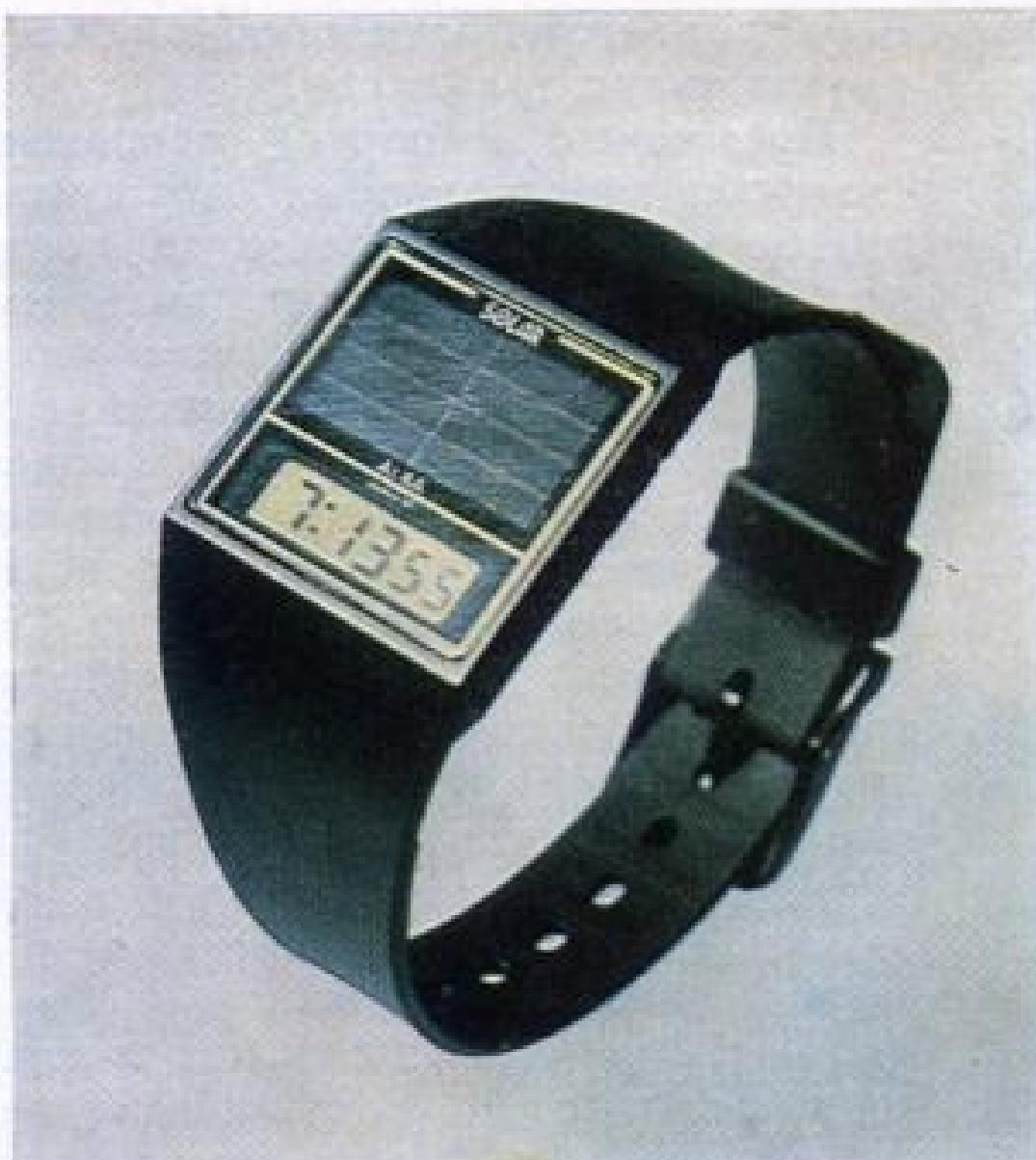
освещении производится в течение 2,7 мин, при освещенности 500 лк от люминесцентной лампы — в течение 1,4 ч. Продолжительность хода часов при полной зарядке составляет 120 ч (около 5 суток) без дополнительной подзарядки. Однако контрастность показаний на дисплее снижается примерно через 3 суток.
