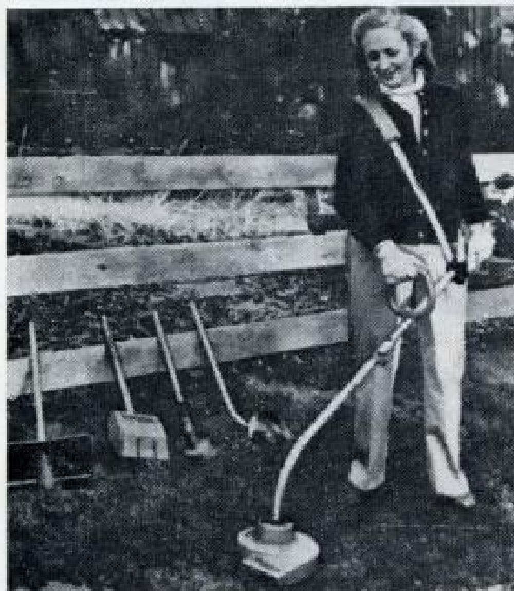
**Универсальный источник мощности в виде бензомотора (1 л. с.) и пять насадок к нему для садово-огородных работ выпустила фирма HMC (США). Насадки легко и быстро сменяются и состоят из плетевой косилки, культиватора, краеподравливателя, воздуховушки для собираания в кучу листвы и скошенной травы и снегомета, очищающего полосу шириной 0,3 м при глубине снега 0,175 м.**
