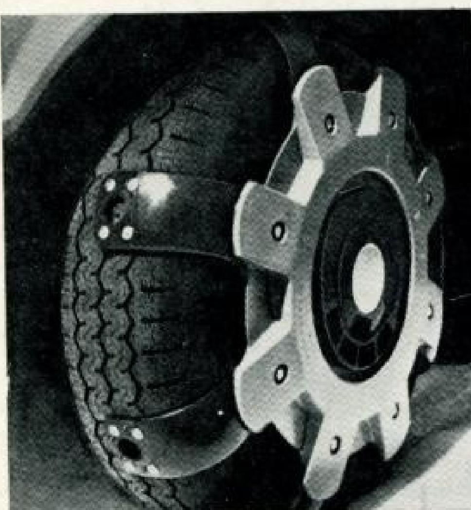
Накладные пластмассовые грунтозацепы для облегчения езды по обледенелым дорогам (фирма Bayer, ФРГ) имеют 8 лап с шипами, обхватывающими с внешней стороны колеса рабочую поверхность протектора. Отличаются легкостью установки.
