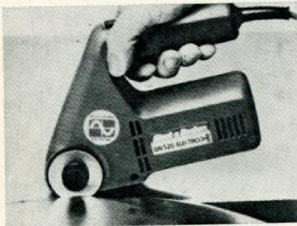
Электрорезак с двумя противоположно вращающимися, рядом стоящими зубчатыми дисками для резки всевозможного тонкого листового материала — картона, дерева, ткани, пласти массы, металлической жести — выпустила фирма Black & Decker (США). Можно делать прямые и дугообразные резы. Кромки получаются почти без заусениц. Диски имеют прямое и обратное вращение. Имеется также предохранительная фрикционная муфта. Масса резака — 1,6 кг.
