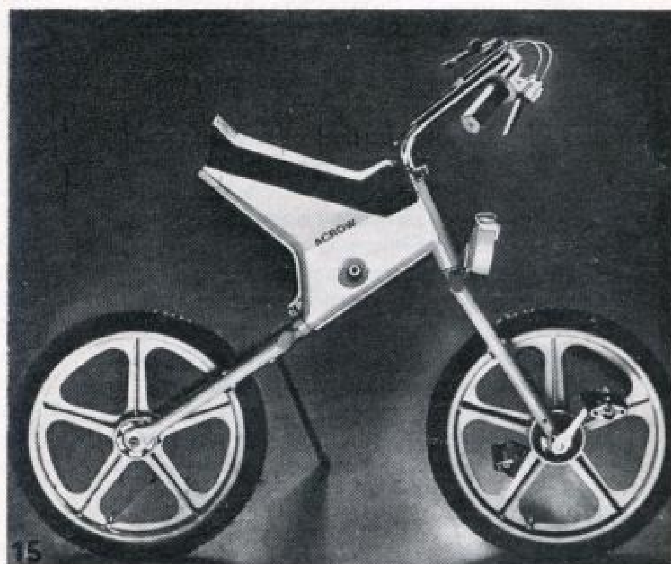
14. Велосипед разборно-складной конструкции, трансформируемый в грузоперевозочный (Голландия) 15. Велосипед оригинальной конструкции с приводом на переднее колесо (Австрия)
