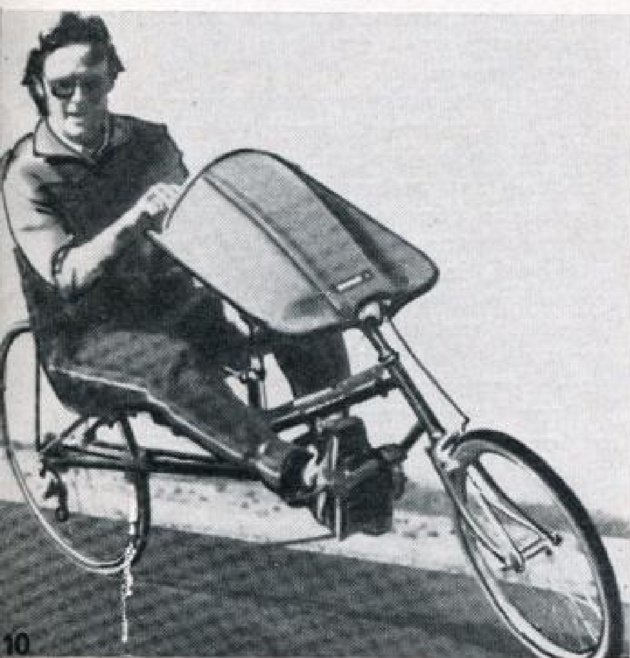
10, 11. Велосипеды оригинальной конструкции, в решении которых предусмотрены средства, снижающие сопротивление встречного потока воздуха. При наличии легкого кузова-обтекателя могут быть преобразованы в автомобили
