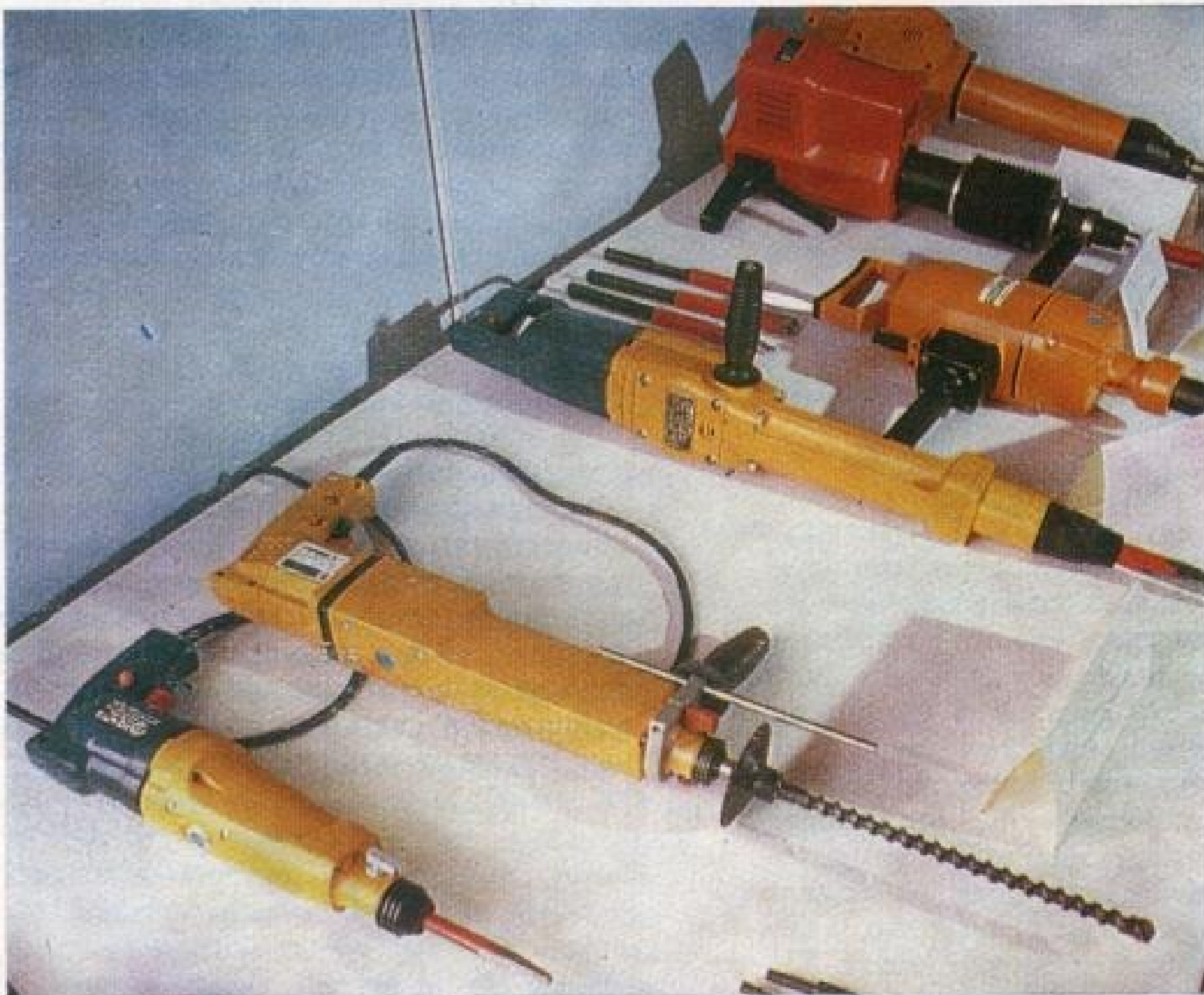
5. Ручной элетрифицированный инструмент. Построение цветового решения на двух сильно контрастных цветах делает рабочую часть инструмента четко выраженной, что эргономически оправдано
