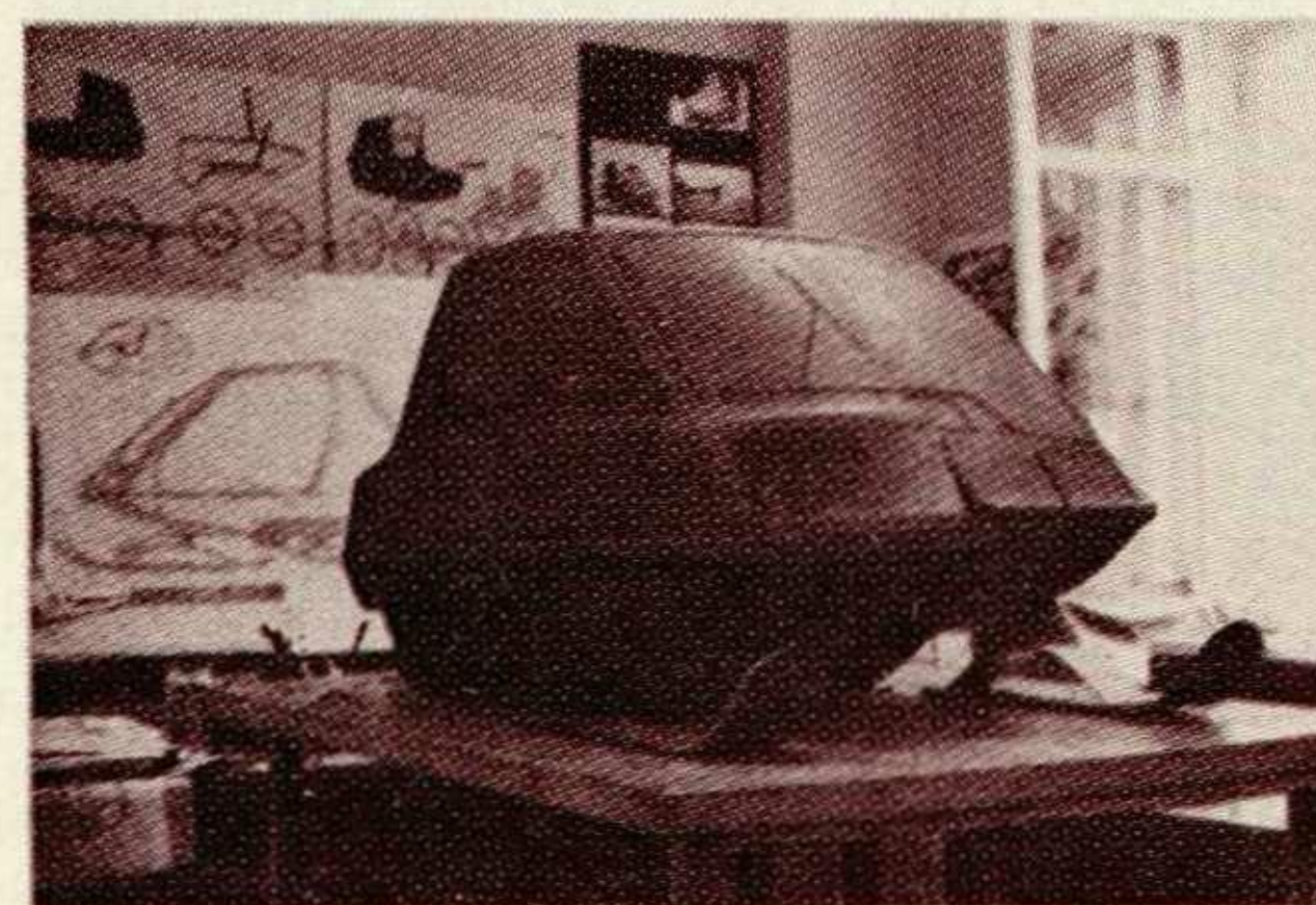
1. а, б, в. Поисковый макет снегохода. Пласталин. Масштаб 1:2,5.
