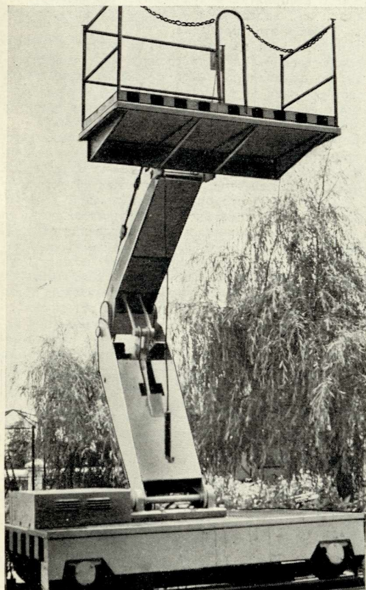
1, 2. Универсальная площадка сварщика ПСУ 4/2. Авторы художественно-конструкторской части проекта В. Гурский, Д. Шмельков, Н. Лебедев (Киевский филиал ВНИИТЭ).
