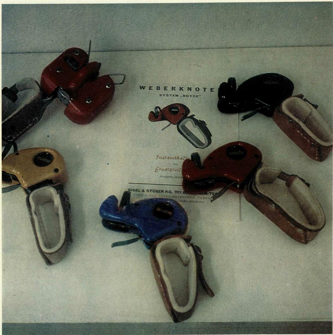
9 а, б. Узловязатели системы «Боусе» для ткацкого узла фирмы Штюбер К. Г. (ФРГ). Узловязатель образует небольшие равномерные узлы с короткими прилипающими к нити концами, которые автоматически обрезаются. Узлы образуются простым нажатием собачки. Малогабаритный, удобный для работы в руке узловязатель имеет гладкую мягкую скульптурную форму корпуса, по которой свободно скользят нить. Он может быть изготовлен в поясном исполнении.
