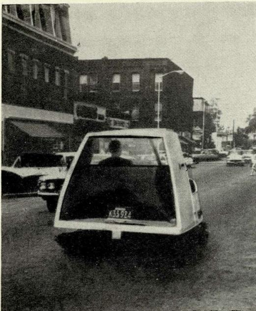
6, 7. Автомобиль «Старркар» системы Олдена, который может двигаться на треке и по дороге. Автомобиль может двигаться с большой скоростью при автоматическом централизованном управлении всей линией.
