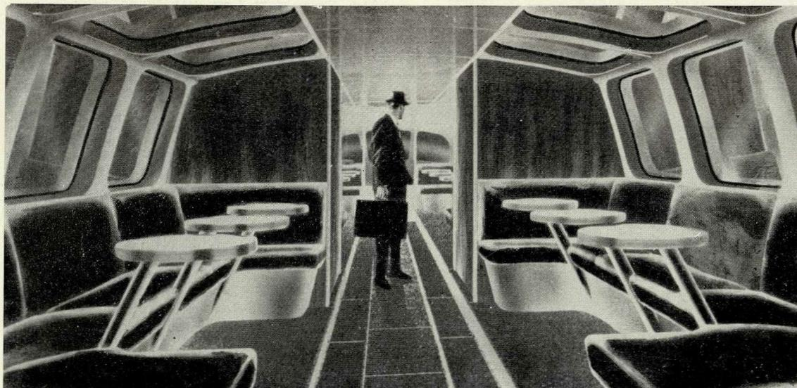
Другое преимущество системы — ее размеры. Поскольку размеры каждого вагона небольшие ( $12 \times 2,8 \times 1,5$  м) и они значительно меньше обычных железнодорожных вагонов, всю систему будет легче встроить в окружающий городской ландшафт или поднять ее над центральной частью автомобильной дороги.
