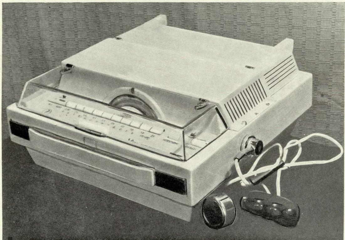
Настольная десятиклавишная вычислительная машина «Вега» автоматически выполняет все 4 арифметических действия, извлечение корня, умножение на постоянный множитель и др. Машина полуавтоматически осуществляет деление на постоянный делитель, алгебраическое суммирование частных и другие операции. Машине имеет легкую и удобную клавиатуру. Набираемые числа и результаты вычислений индицируются на экране.
