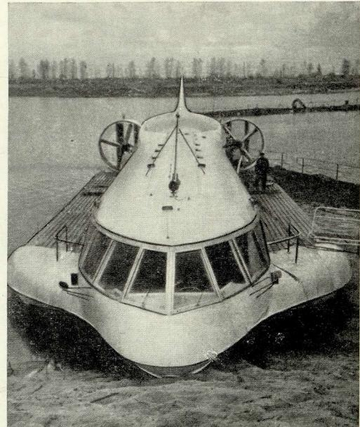
Быстроходный речной экспресс «Сормович» — первый пассажирский корабль на воздушной подушке, изготовлен заводом «Красное Сормово» (г. Горький). Высота полета корабля над водой — 20—30 см, скорость 120 км/час.
