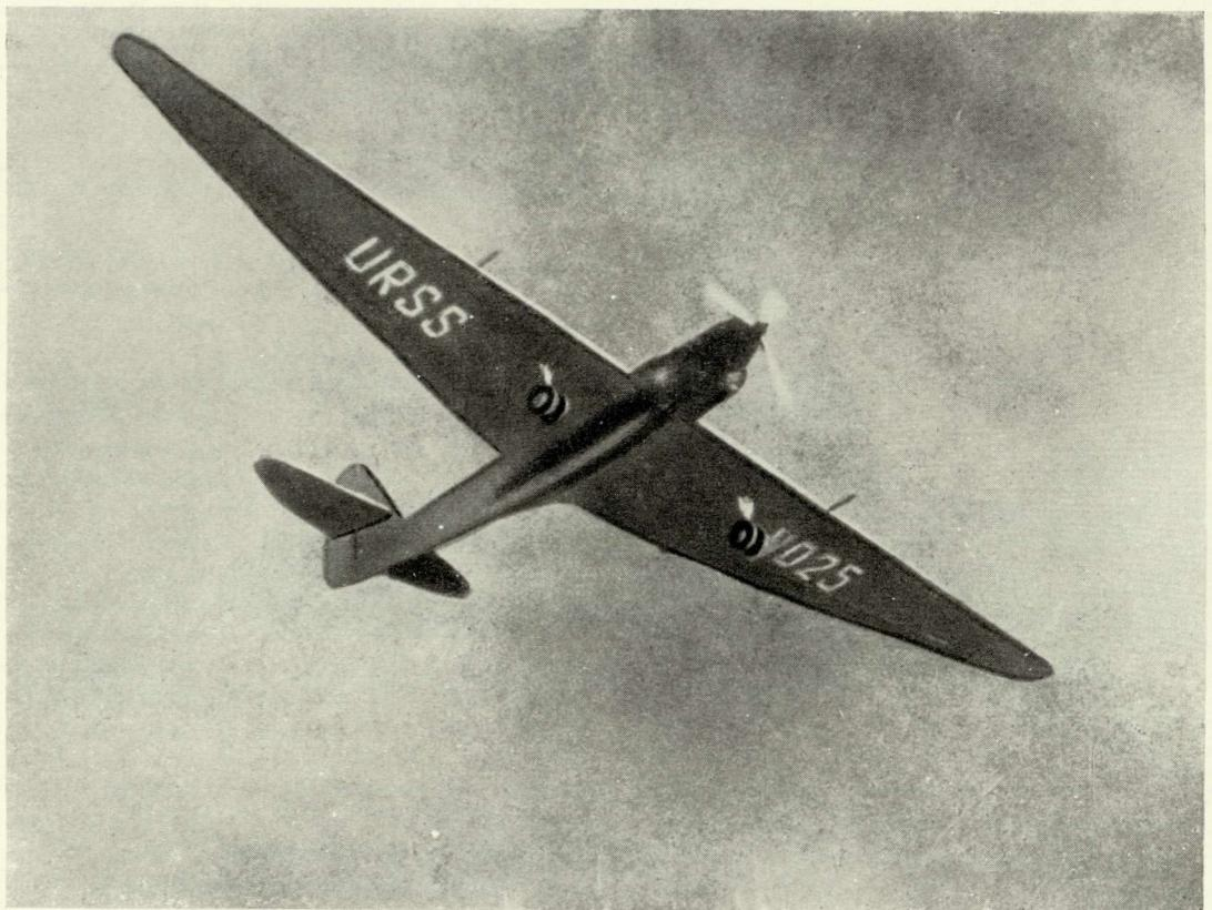
Цельнометаллический самолет-моноплан АНТ-25 конструкции П. Сухого (под руководством А. Туполева). Расчетная дальность полета — 15 000 км. 1933 г.
