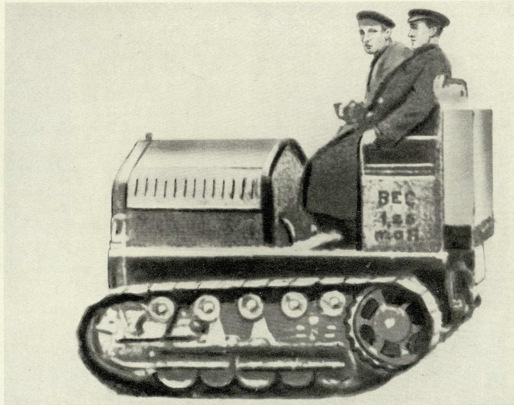
Гусеничный трактор «Большевик» с бензиновым двигателем мощностью 40 л. с. 1918 г.
