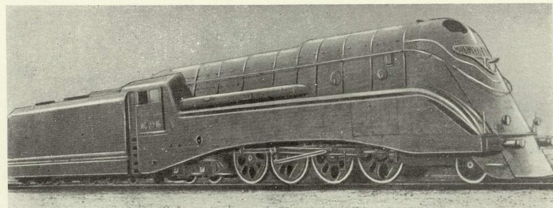
В 1937 г. Луганский паровозостроительный завод построил первый опытный обтекаемый паровоз ИС 20-16 с дисковыми колесами, конструкционная скорость 150 км/час.
