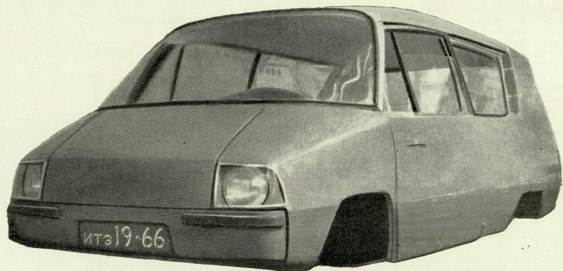
3. Кузов автомобиля, изготовленный из стеклопластика.
