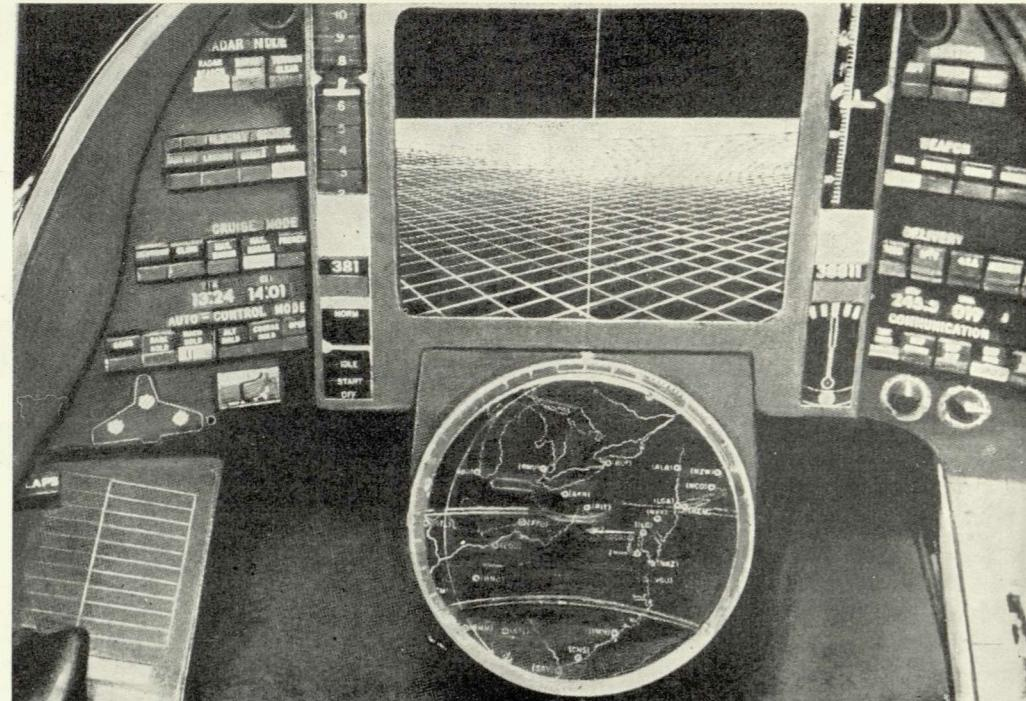
5. Общий вид проектируемой приборной доски с телевизионными индикаторами вертикального и горизонтального положения самолета.
