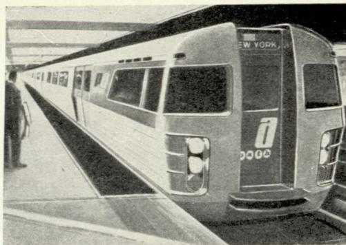
Экспериментальный вагон надземной дороги спроектированный в Чехословакии. Как видно, условия работы и скоростные характеристики такого вида транспорта позволяют применять здесь принципы самолетостроения.
