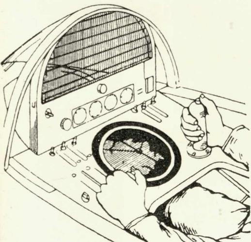
7. Макет приборной панели с электроннолучевым индикатором вертикального положения. Прямо под индикатором вертикального положения—индикатор горизонтального положения.
