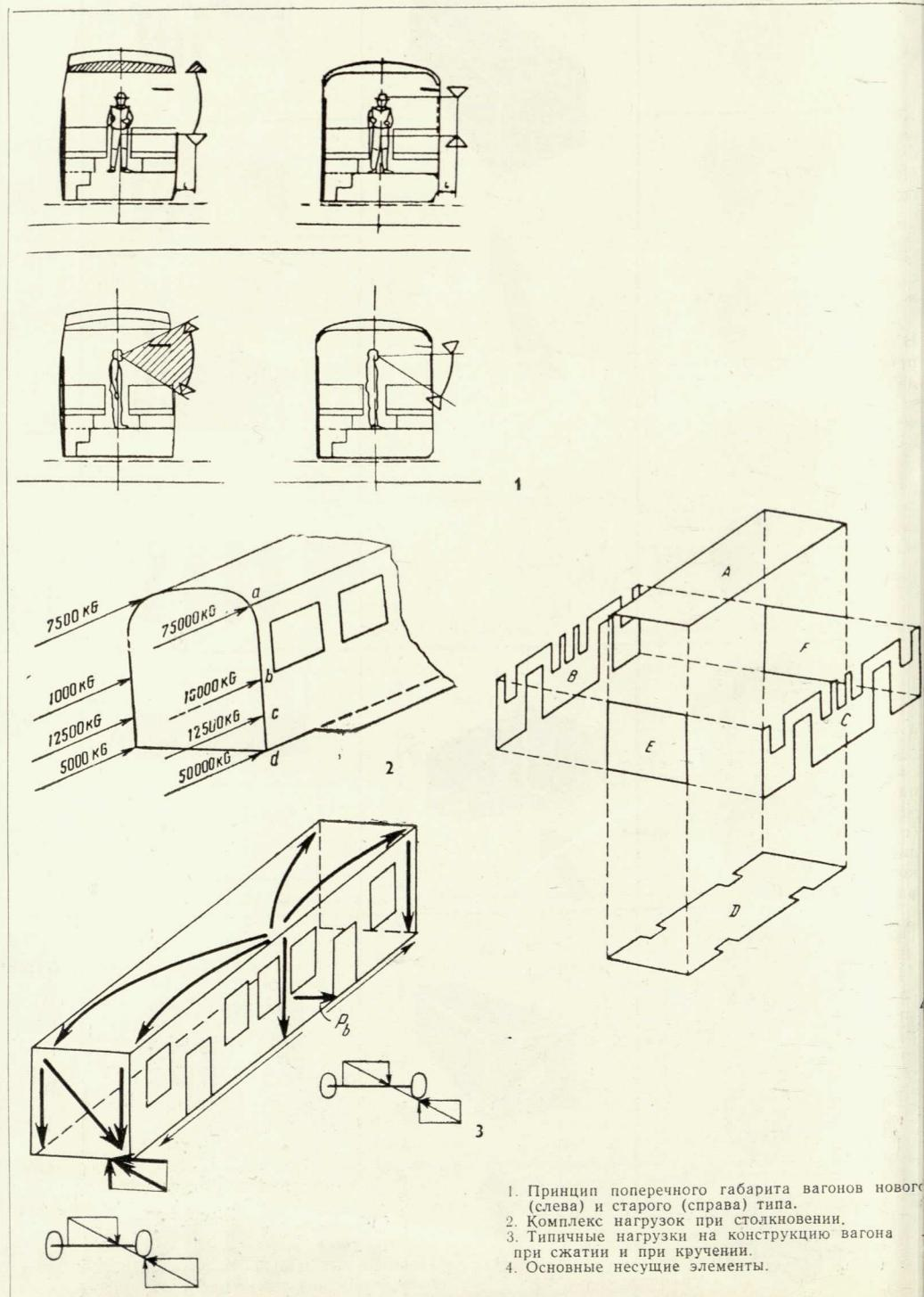
1. Принцип поперечного габарита вагонов нового (слева) и старого (справа) типа.
