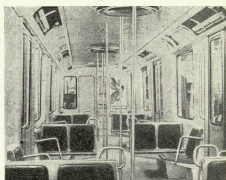
Электропоезд метрополитена в Сент-Луисе, США. Вагоны, спроектированные фирмой Пат, облицованы неокрашенным алюминием и армированы сталью. Нижняя зона параллельно-линейно разграфлена и оканчивается спереди в гнездах для встроенных фар. Верхняя оконная часть вагона наклонена под углом к нижней зоне. Для оформления интервала использован легкоочищаемый пластик ярких расцветок.
