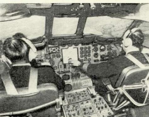
5. Общий вид кабины экипажа самолета «Трайдент». Несмотря на насыщенность и «плотную» компоновку агрегатов, таких как приборная доска, кресла, центральный пульт, летчики имеют достаточно хороший обзор через остекление фонаря.
