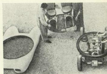
8. Ze-ze. В машине имеется двигатель объемом 500 см<sup>3</sup> с воздушным охлаждением. Автомобиль двухместный. Имеет пластмассовый кузов и открывается спереди. Может поворачиваться на радиус, равный длине машины.
