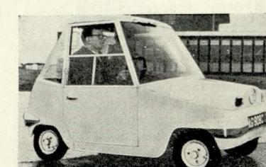
15. Эскиз городского электрического автомобиля с мотором в задней части, работающим от батареи с постоянным питанием (fuel-cell). Проект создан художественно-конструкторской фирмой Ogle Design Ltd.
