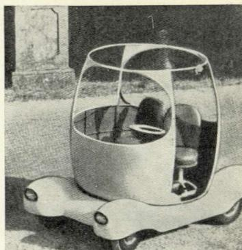
7. Urbanina. Автомобиль разбирается на 4 части. Здесь показаны три части: шасси, платформа с сиденьями и капот. Четвертую часть — кузов — в хорошую погоду можно не использовать.
