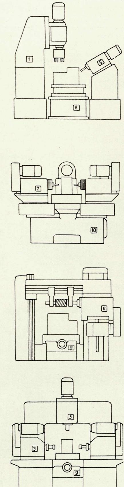
1. Унифицированные и нормализованные узлы, позволяющие компоновать агрегатные станки различного функционального назначения. Унификация межтиповая.
