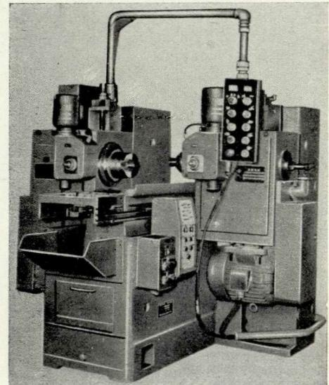
6. Конструкция форм отдельных функциональных узлов и различные пространственные компоновки гаммы унифицированных фрезерных станков фирмы Тойо Кинкай Коэ (Япония).
