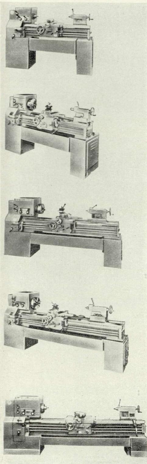
4. Размерный конструктивно-нормализованный ряд гаммы токарно-винторезных станков фирмы Ле Блонд о/ф Цинциннати (США).
