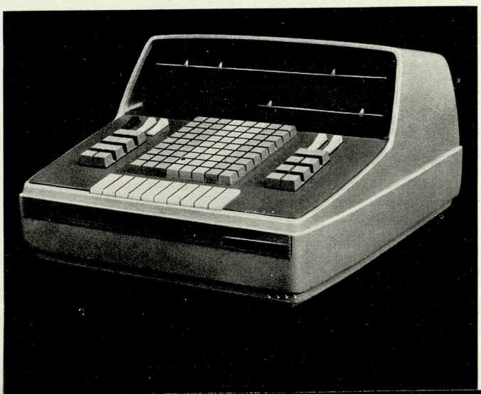
Чтобы обеспечить свободный шарнирный отвод рамы с панелью клавиатуры, был сделан вырез в передней стенке нижней части кожуха. Этот вырез закрывается декоративной накладкой с названием машины.
