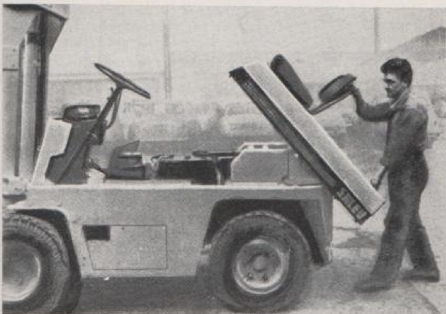
6. В последней модели капот откидывается назад.
