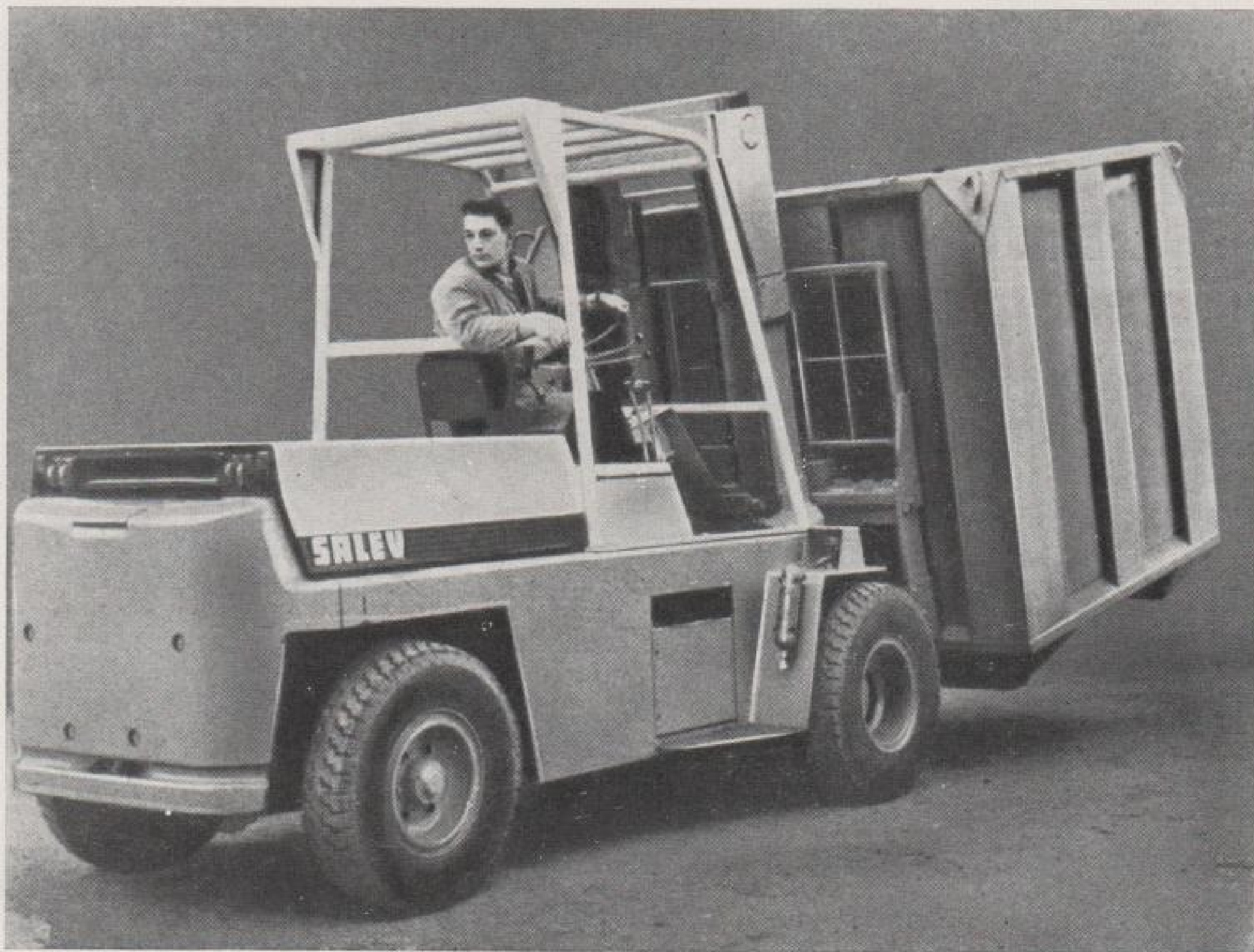
Пятитонный погрузчик фирмы Salev. Модель разработана совместно с художественно-конструкторским бюро Technès. Все элементы формы определяются их функциональным назначением. Фонари над противовесом защищены капотом.
