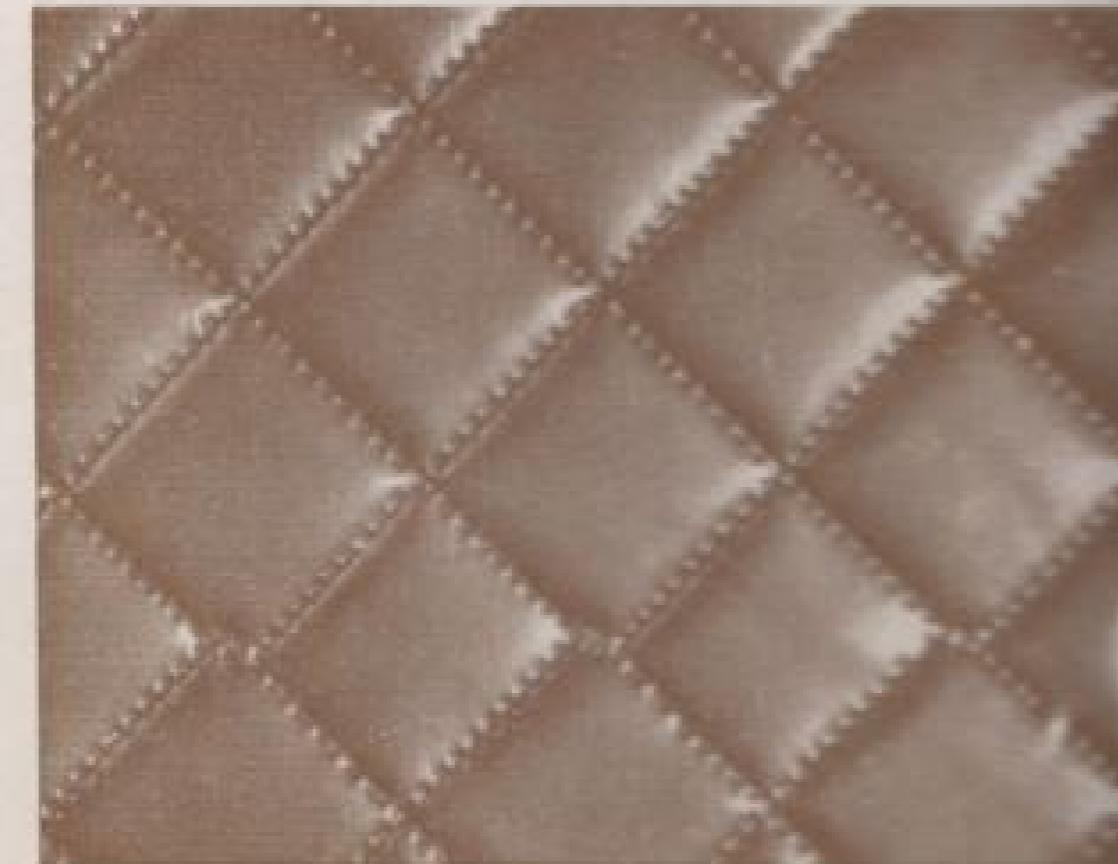
*Использование метода высокочастотной сварки при создании рулонных слонистых материалов позволяет вырабатывать их с различными рисунками тиснения (по линиям сварки).*
