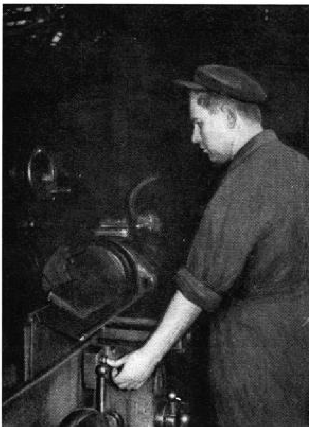
Панель расположена в удобной зоне, и шлифовщику легче манипулировать кнопками.
