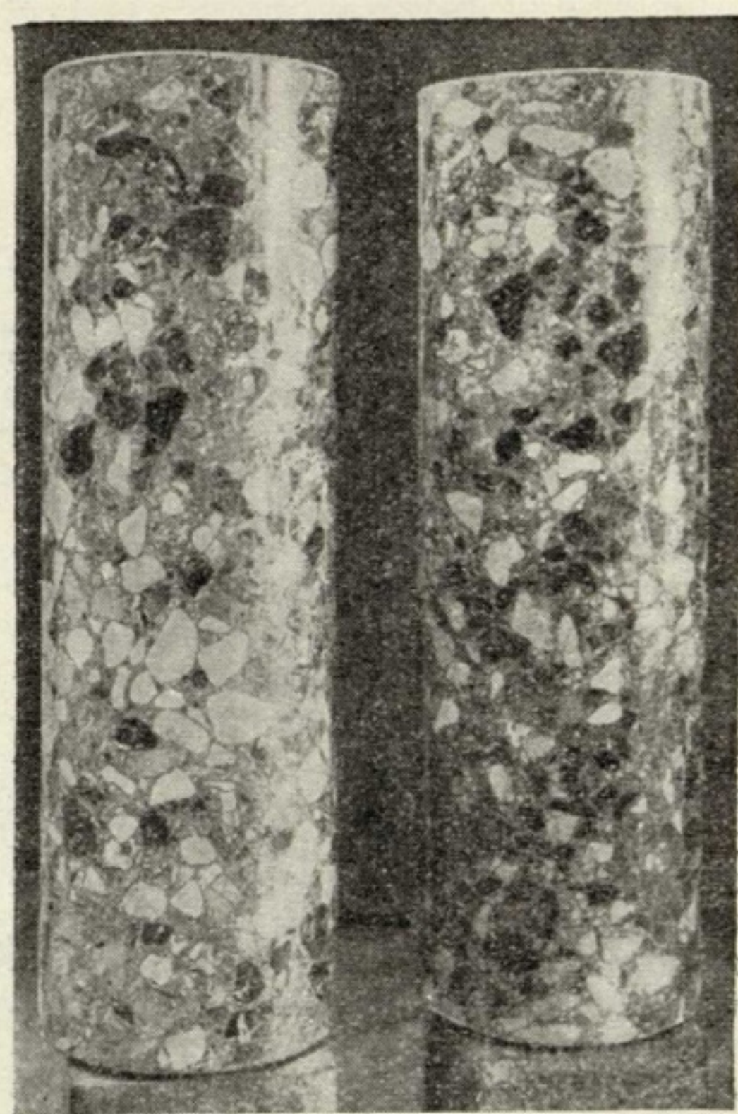
Рис. 4. Цилиндрические акархитовые колонны, отформованные методом центрофугирования.
