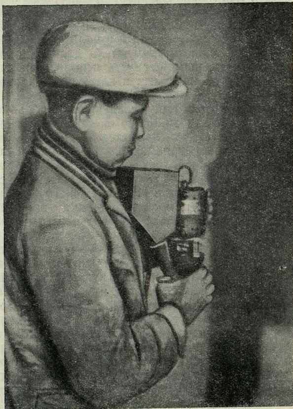
Рис. 2. Краскораспылитель КУ-100 в рабочем состоянии
