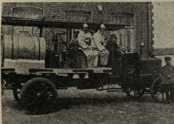
Пожарный автомобиль, отремонтированный рабочими Подольской городской пожарной команды из негодного грузовика.
