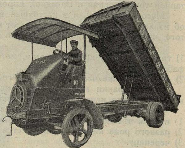
Рис. 3 Грузовик для вывозки отбросов без крышки, с приспособлениями другого рода, для сваливания их на три стороны. Наклон назад.
