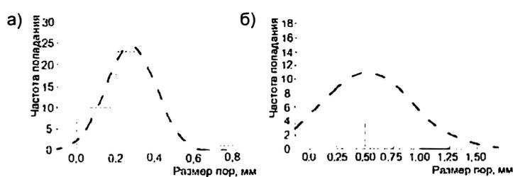
Рис. 4. Гистограмма распределения размеров пор в золобетонах
