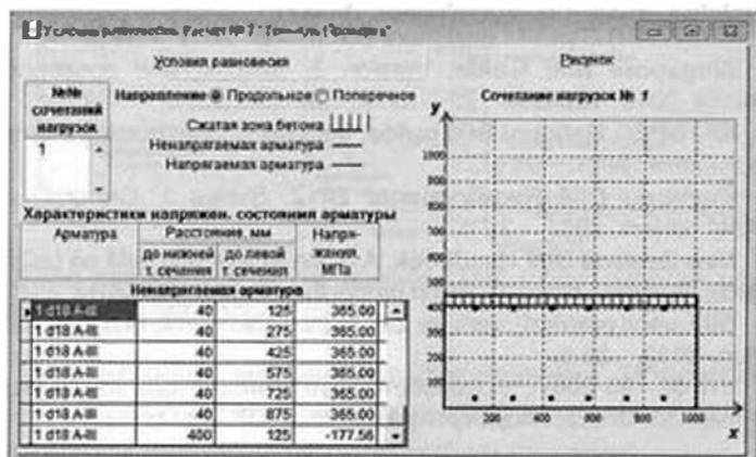
Рис. 2. Расчетная схема сечения обделки тоннеля
