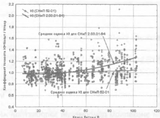
Рис. 5. Распределение значений коэффициента точности  $K_t = N_{\text{опыт}} / N_{\text{теор}}$  в зависимости от класса бетона для методик расчета актуализированного СНиП и СНиП 2.03.01-84
