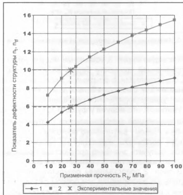
Рис. 2. Зависимость изменения показателей дефектности структуры  $n_t$  (1) и  $n_{tf}$  (2) от призменной прочности  $R_b$
