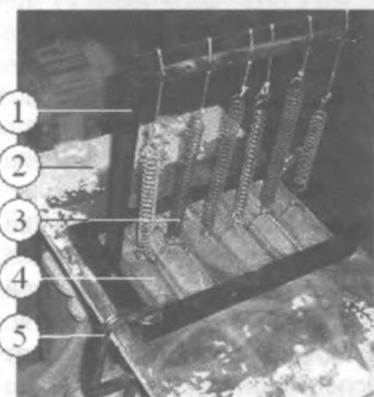
Рис. 3. Общий вид установки для испытания нагруженных образцов пластин
