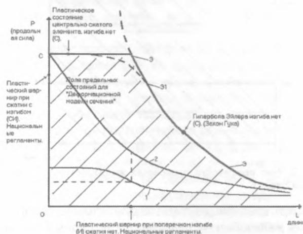
Рис. 1. Поле предельных состояний, соответствующих деформационной модели сечений железобетонных балок и колонн
