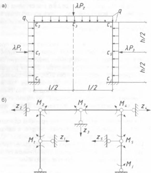
Рис. 2. Расчетная схема (а) и основная (б) система неординарного смешанного метода для анализа живучести рамы
