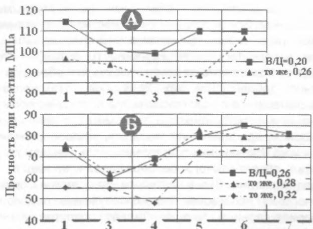
Рис. 4. Прочность пластифицированных (А) и бездобавочных (Б) образцов: эталонных (1), через 15 (2), 30 (3), 75 (4) минут вибрации, спустя три часа (5), одни (6) и трое (7) суток после уплотнения
