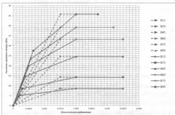
Рис. 1. Расчетные диаграммы деформирования бетонов различных классов по прочности
