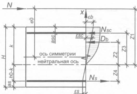
**Рис. 2. Схема расчетной модели внерадиально сжатого железобетонного элемента в начальный момент загружения**
