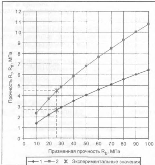
Рис.1. Зависимость между прочностью на осевое растяжение (1) и растяжение при изгибе (2) от призменной прочности
