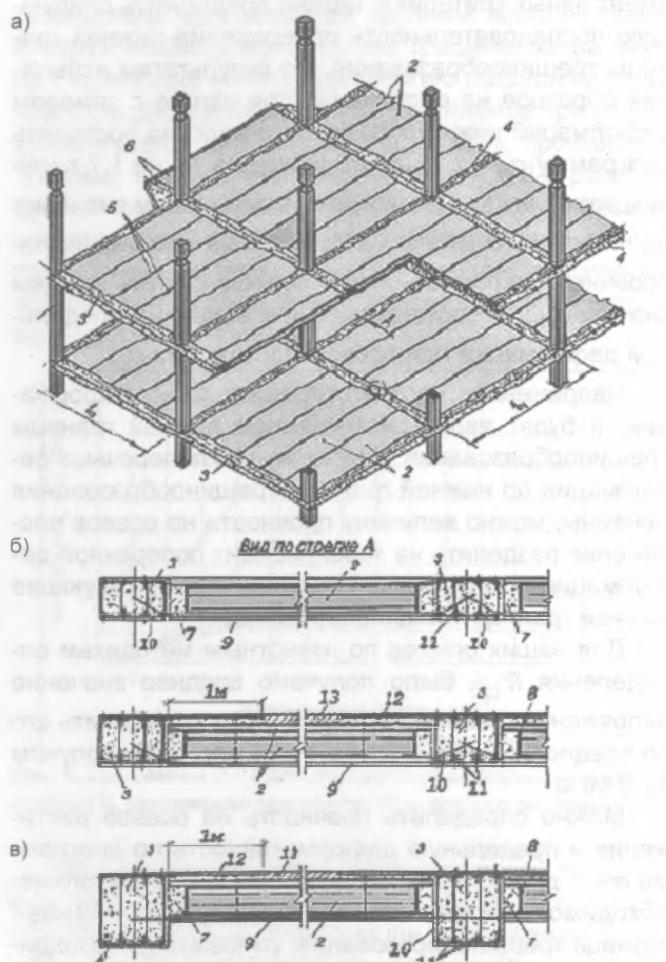
Рис. 1. Конструкция каркаса и варианты поперечных сечений несущих ригелей в пролетах между колоннами
