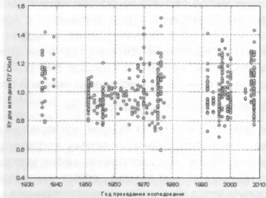
Рис. 4. Распределение значений коэффициента точности  $K_t = N_{\text{опыт}} / N_{\text{теор}}$  в зависимости от года проведения испытаний для методики расчета по предельным усилиям актуализированного СНиП
