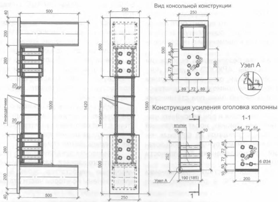
Рис. 1. Каркас опытного образца вместе со съемной консольной конструкцией
