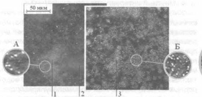
Рис. 1. Общий вид обнаженной поверхности клинкерного зерна с нанесенной каплей воды (микроскоп Рейхарда; отраженный монохроматический свет со средней длиной волны 535 нм)
