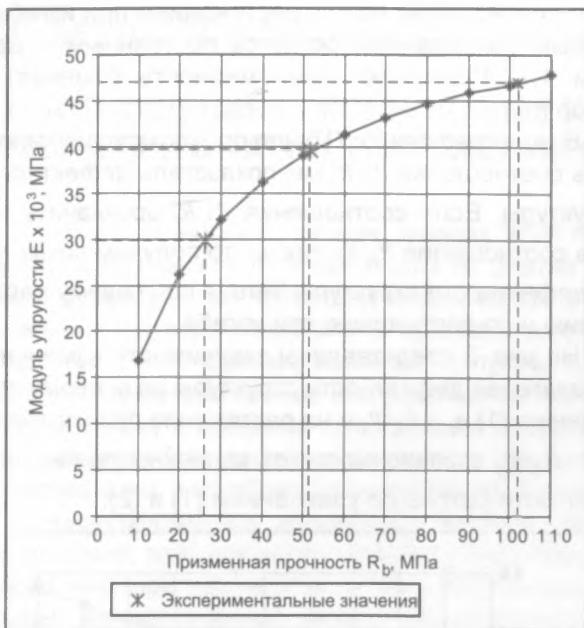
Рис. 3. Изменение модуля упругости от призменной прочности
