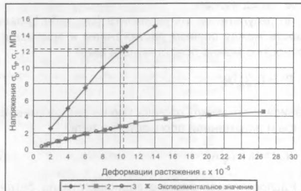
Рис. 4. Диаграммы  $\sigma - \varepsilon$  для поперечных деформаций осевого сжатия (1), растяжения при изгибе (2) и осевого растяжения (3)
