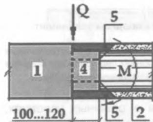
Рис. 5. Схема выкола бетона в опорных кромках плит
