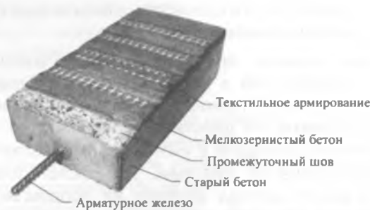
Рис. 1. Принцип работы по усилению текстильным бетоном
