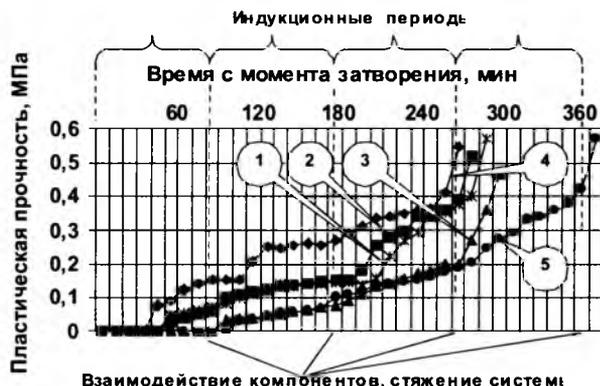
Рис. 3. Кинетика пластической прочности цементного теста с В/Ц=0,22 (1); 0,26 (2); 0,3 (3) и растворной смеси 1:2 с В/Ц=0,4 (4) и 0,5 (5) на новороссийском ПЦ 500-ДО
