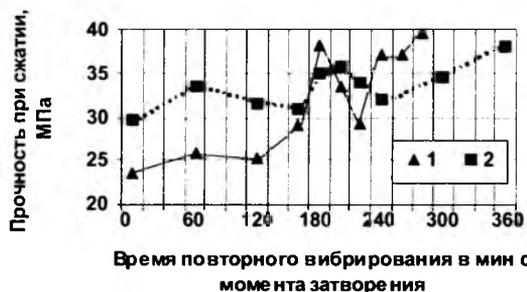
Рис. 2 Влияние времени приложения повторной вибрации на прочность бетона
